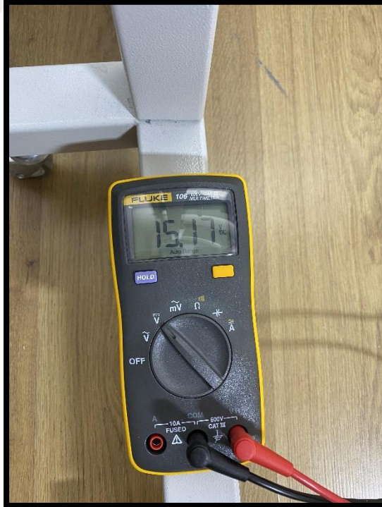
Şekil 4.10. İnce film panel %80 kapalı durumda çıkış voltajı.
