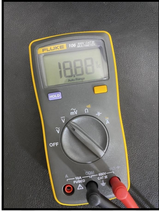
Şekil 4.2. Monokristal panel maksimum çıkış voltajı.
