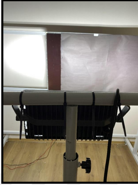
Şekil 4.9. İnce film panel %80 oranında ışık almıyor durumda.
