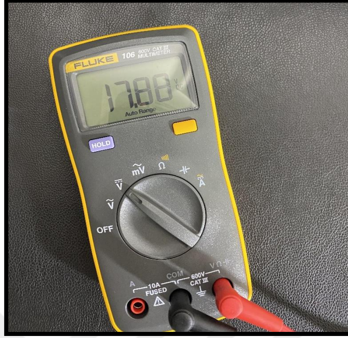
Şekil 4.6. Polikristal panel maksimum çıkış voltajı.
