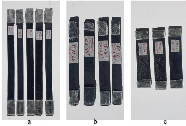
Şekil 61. (a) 0° takviye açılı test numunesinin bitmiş hali, (b) 45° takviye açılı test numunesinin bitmiş hali, (c) 90° takviye açılı test numunesinin bitmiş hali
