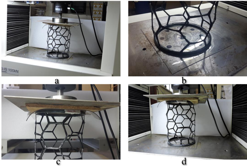
Şekil 63. (a) Anizogrid numune için burkulma testi, (b) Alt flanş oturma lastiği, (c)Üst flanş üzerindeki lastik, ahşap ve metal plaka, (d) Burkulmuş numune
