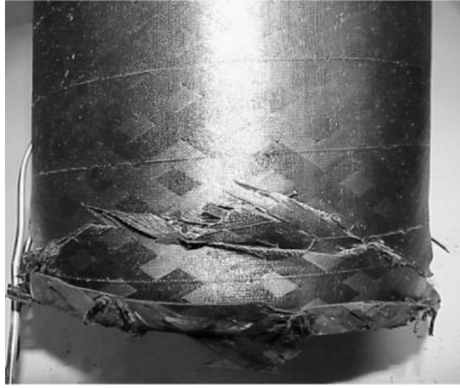
Şekil 5. Sertleştirilmiş kompozit silindir üzerinde test sonucu
