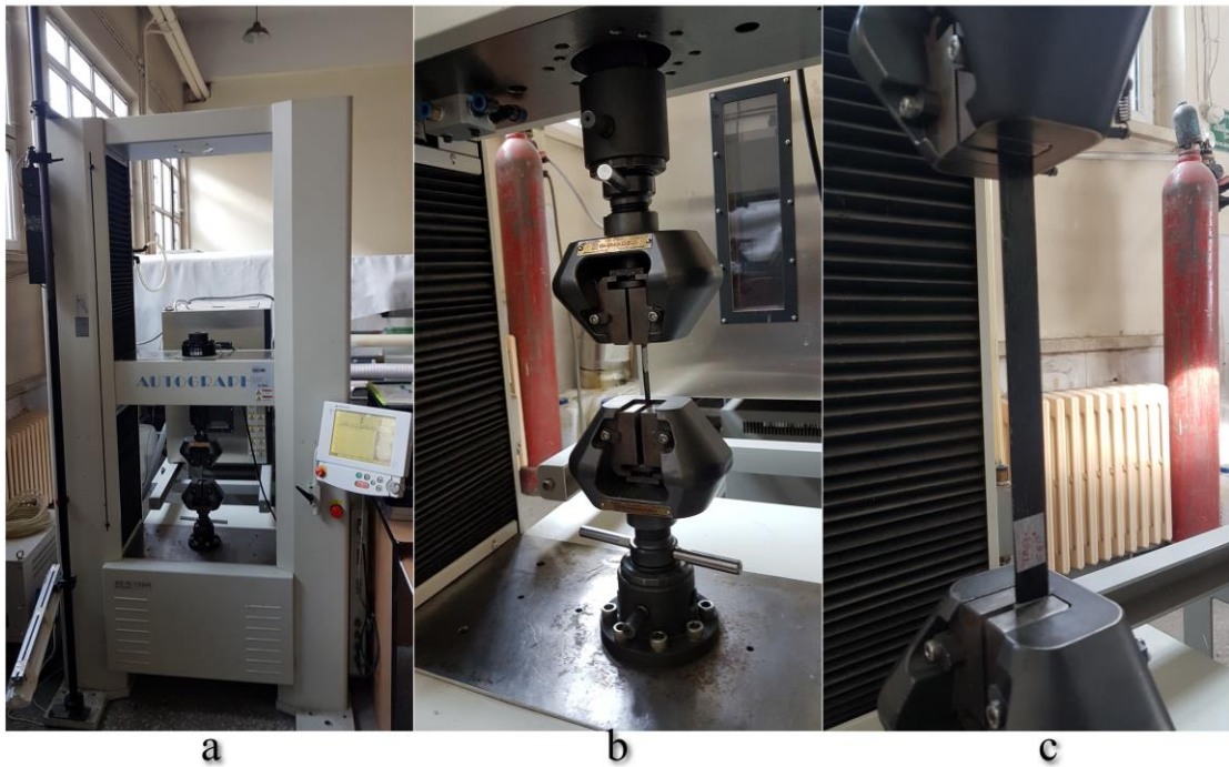
Şekil 62. (a) Çekme testi cihazı, (b) Çekme cihazının tutucu çeneleri, (c) Çekme esnasında numunenin görünüşü
