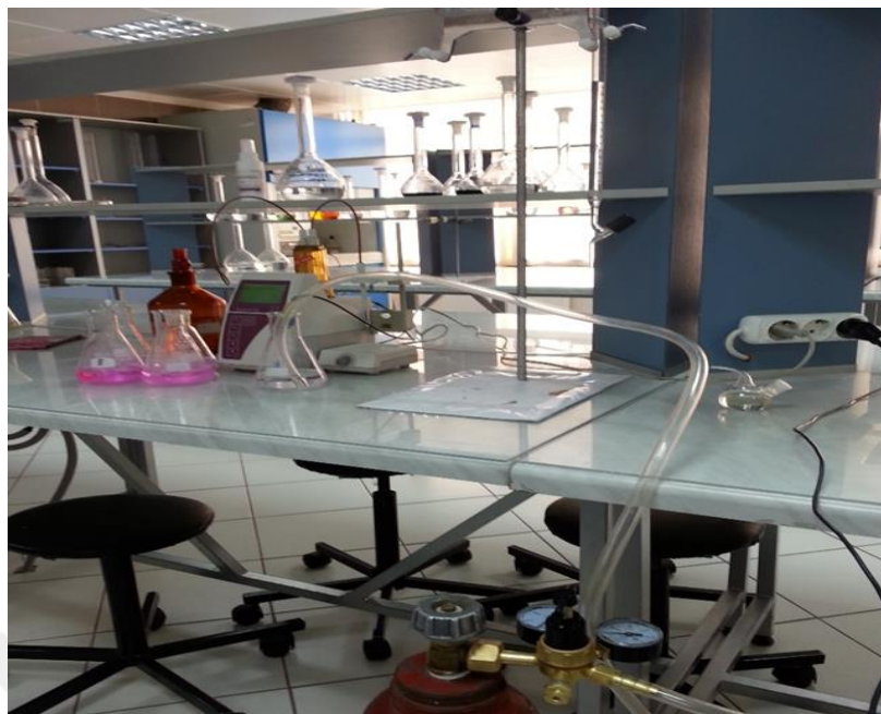
Сүрөт 2.1.3. Моделдик суу үлгүсүндө көмүртектин кош кычкылынын концентрациясын жогорулатуу менен рН маанисин аныктоо
