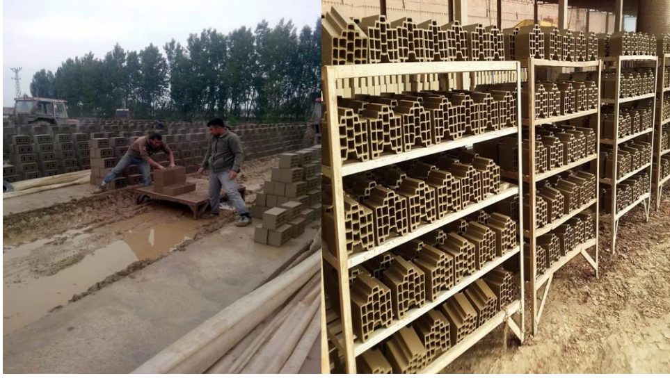
Şekil 3: Sehbada ve stok yöntemi ile açık havada kurutma
