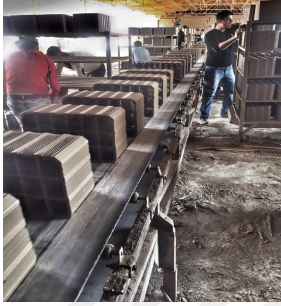
Şekil 2. Şekil verilmiş tuğlanın raflara yerleştirilmesi
