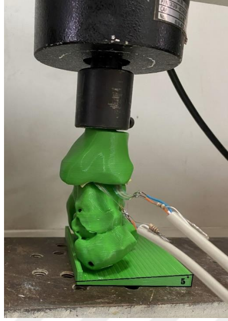
Şekil 15. Talusun Lateral Tilt Deney Düzenegi
