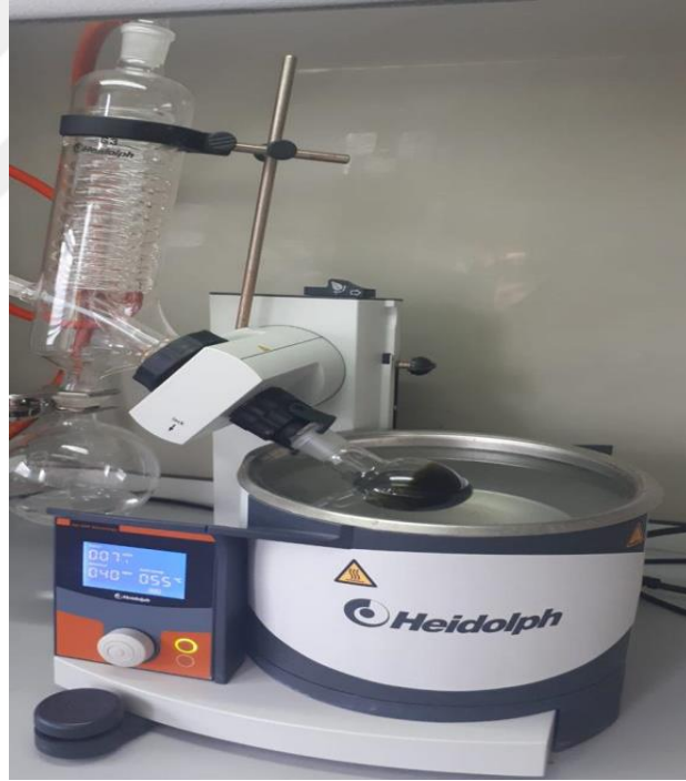
Şekil 3.2. Rotary evaporatörde (Heidolph Hei VAP Precision, Almanya) evaporasyon işlemi
