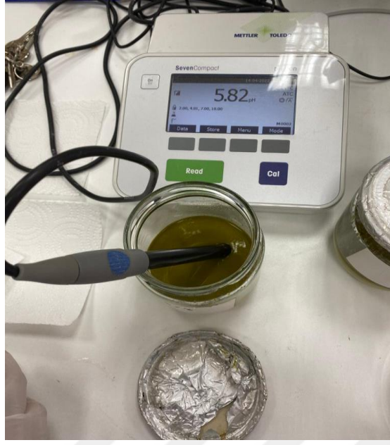
Şekil 4.1. Dekontaminasyon solüsyonlarının Mettler Toledo S220 Seven Compact pH/iyon metre ile ölçümü
