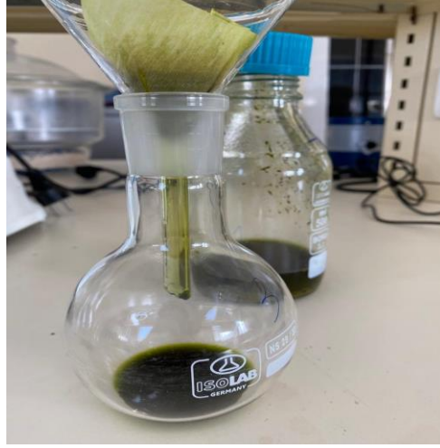
Şekil 3.1. Ekstraktın Whatman no 1 filtre kâğıdı ile balonjoje içerisine süzülmesi
