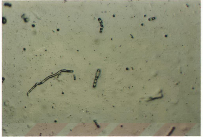
Şekil 4.10a. Polarizan mikroskopta %100 su formüllü filmin fotoğraf görüntüsü (2.5X objektifte)
