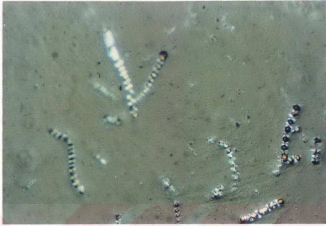
Şekil 4.10g. Polarizan mikroskopta P8000 formüllü filmin fotoğraf görüntüsü (2.5X objektifte)
