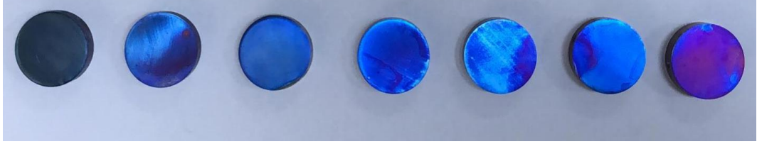
Şekil 4.7 Anotlama süresine göre anotlama numuneleri
