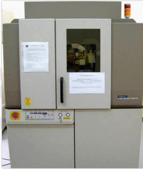
Şekil 3.6 X-ışını Difraktometresi, Rigaku, D/Max-2200/PC (Kişisel arşiv, 2023)
