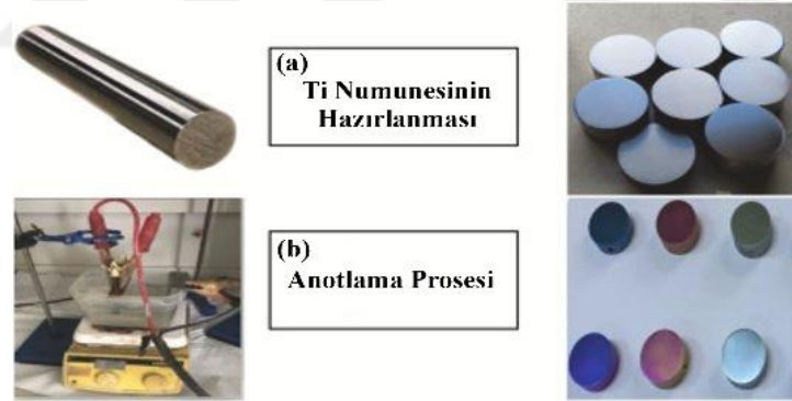
Şekil 4.15 (a) Numune hazırlama ve (b) anodizasyon prosedürleri
