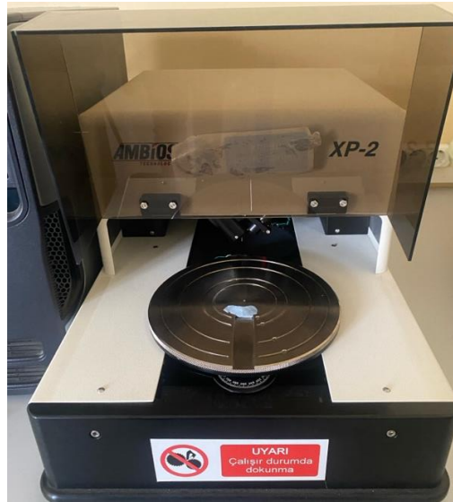
Şekil 3.2 Yüksek çözünürlüklü yüzey profilometresi sistemi, Ambios Technology - XP-2 (Kişisel Arşiv, 2023)
