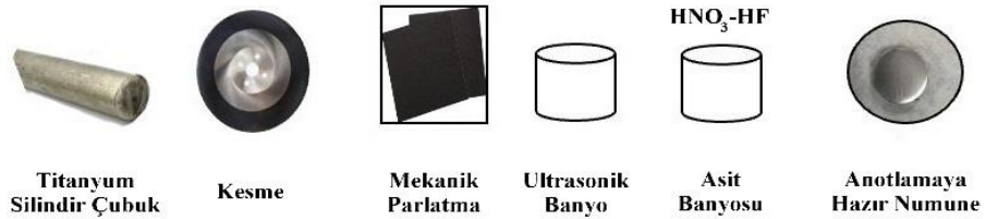
Şekil 3.1 Ti numunelerinin anodizasyon işlemine hazırlanması
