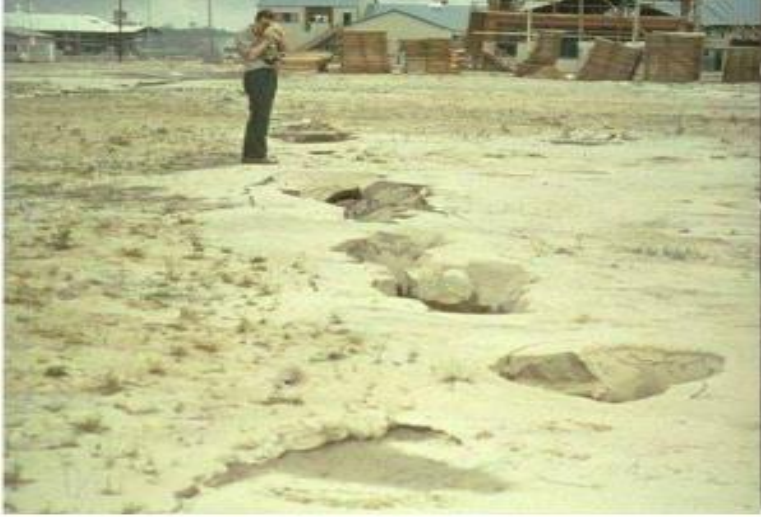
Resim 2.6. Niigata’da meydana gelen kum kaynamaları (Oyan, 2019).
