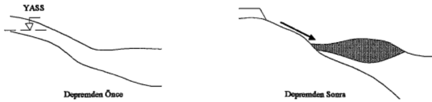
Şekil 2.2. Akma göçmesinin şematik gösterimi (Uyanık,2002).
