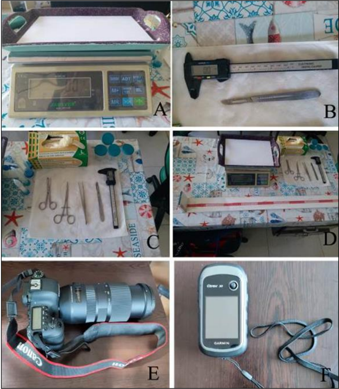
Şekil 3.4. Dikenli yılanbalığı araştırmasında kullanılan malzemelere ait görüntüler (A-hassas terazi, B-Dijital Kumpas, C- Diseksiyon Takımı, D- Ölçüm Tahtası, E- DSLR Fotoğraf Makinesi ve F-GPS)
