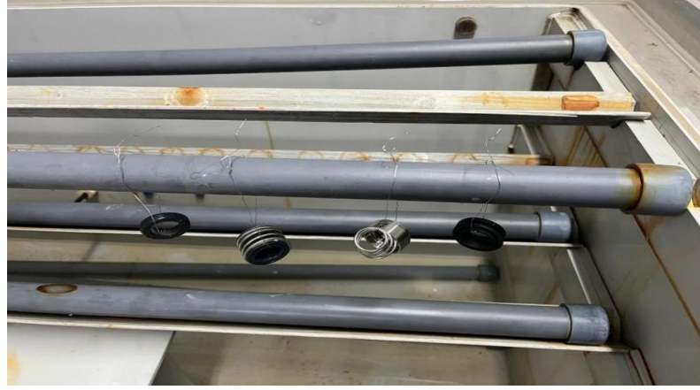
Şekil 6.11. Numunelerin kabin içerisinde yerleştirilmesi
