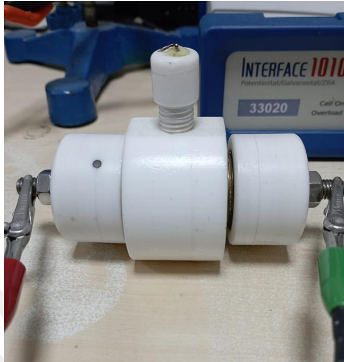
Şekil 2.6. Swagelok hücresi ile süperkapasitör test işlemi.
