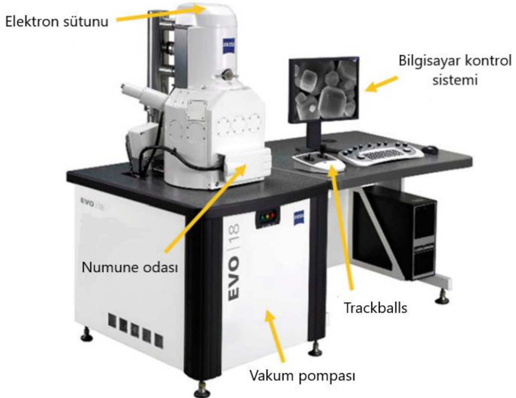
Şekil 2.7. SEM cihazının ana bileşenleri [97].
