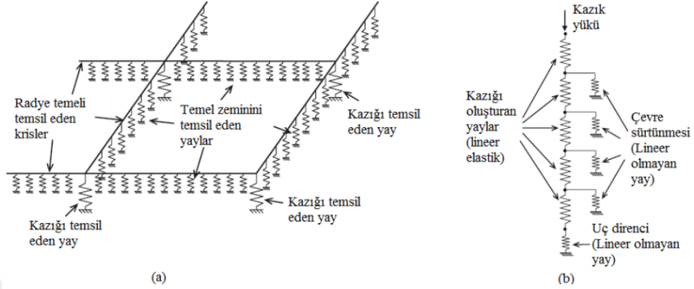
Şekil 2.4 : Yaylar üzerinde şerit metodu kullanım, (a) kazıklı radye sisteminin kiriş ve yaylar aracılığıyla modellenmesi, (b) ise kazıkların ve çevresindeki zeminin yaylar ifade edilmektedir.
