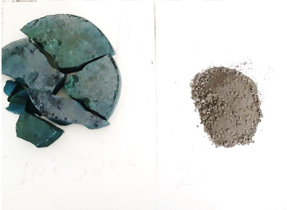
Şekil 6.4. Piroliz deneyi sonucunda elde edilen katı maddesi
