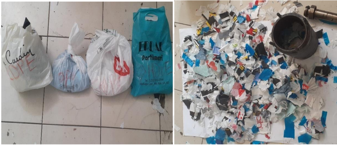
Şekil 6.3. Piroliz deneyi için hazırlanmış malzeme
