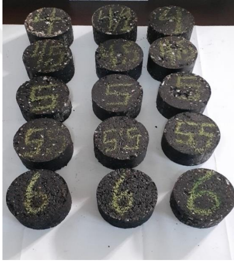
(a) Katkısız bitümle hazırlanmış numuneler
