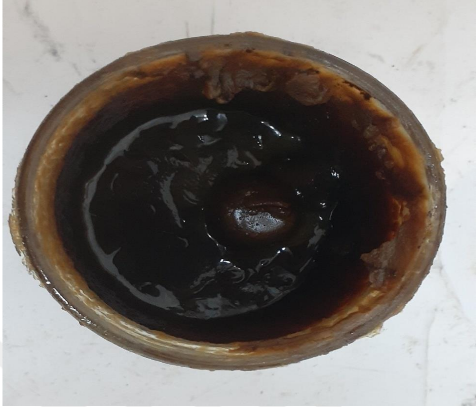
Şekil 6.5. 225°C'lik sıcaklık sonucunda elde edilen piroliz sıvı maddesi
