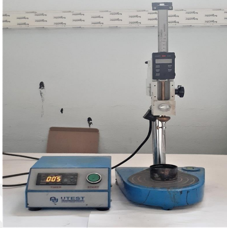
Şekil.4.14. Penetrasyon deney cihazı
