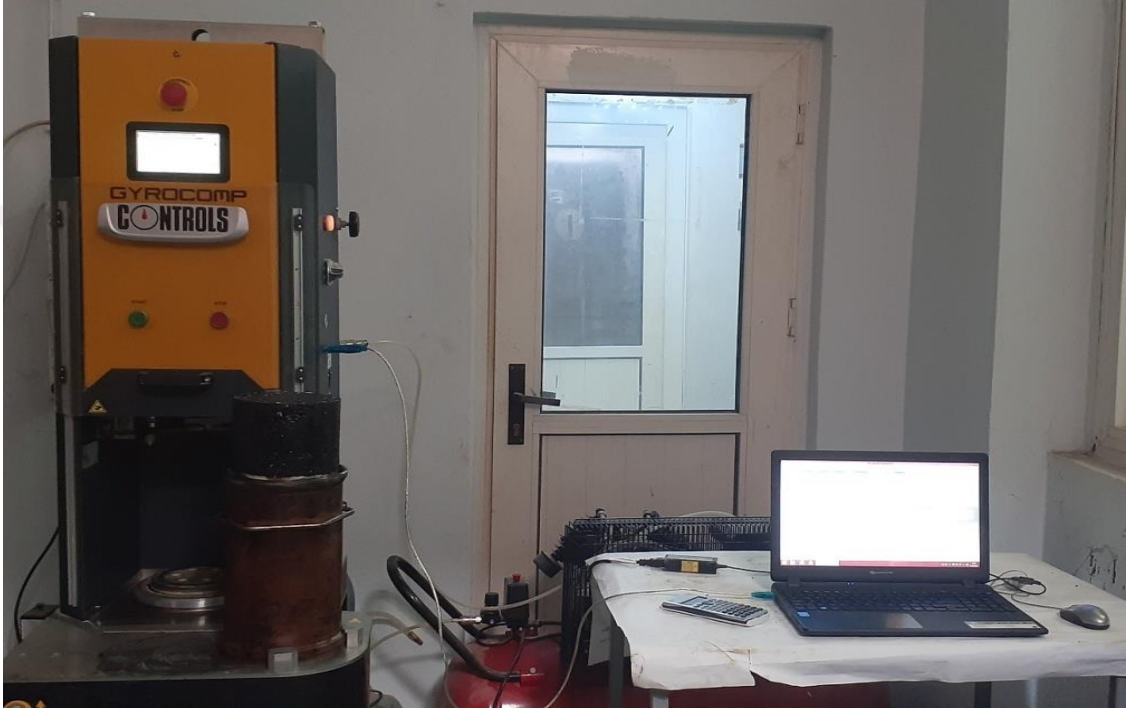
Şekil 5.3. Gayrator Sıkıştırma Makinesi
