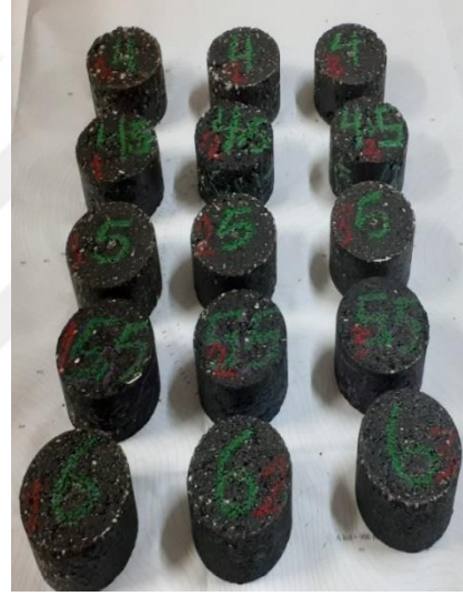
(b) %3 NPP ile hazırlanmış numuneler
