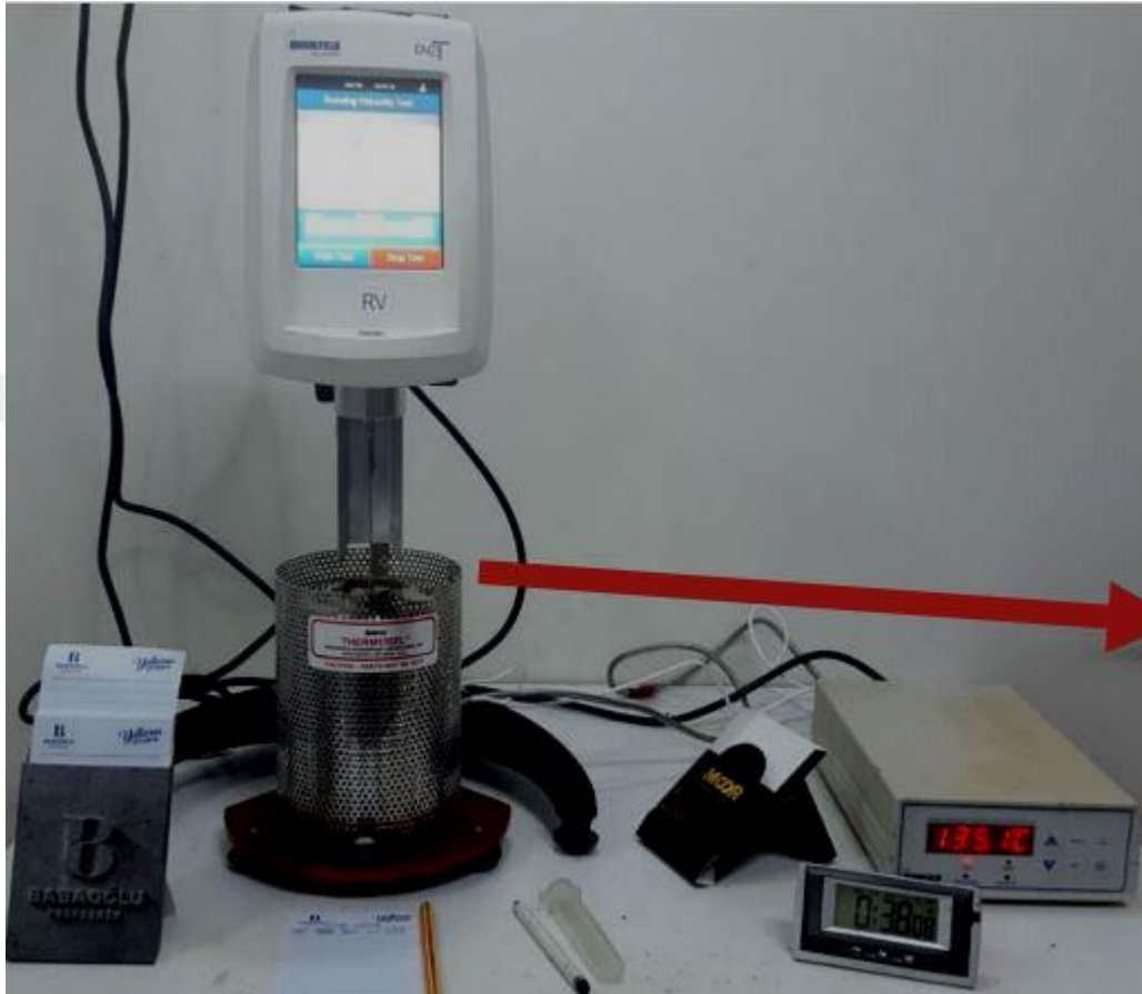
Şekil 4.16. Viskozite deney cihazı
