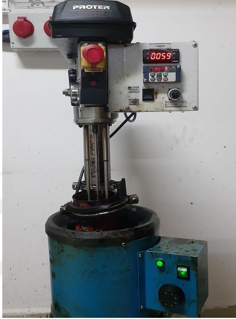
Şekil 4.17. Bitüm bağlayıcı modifiye cihazı
