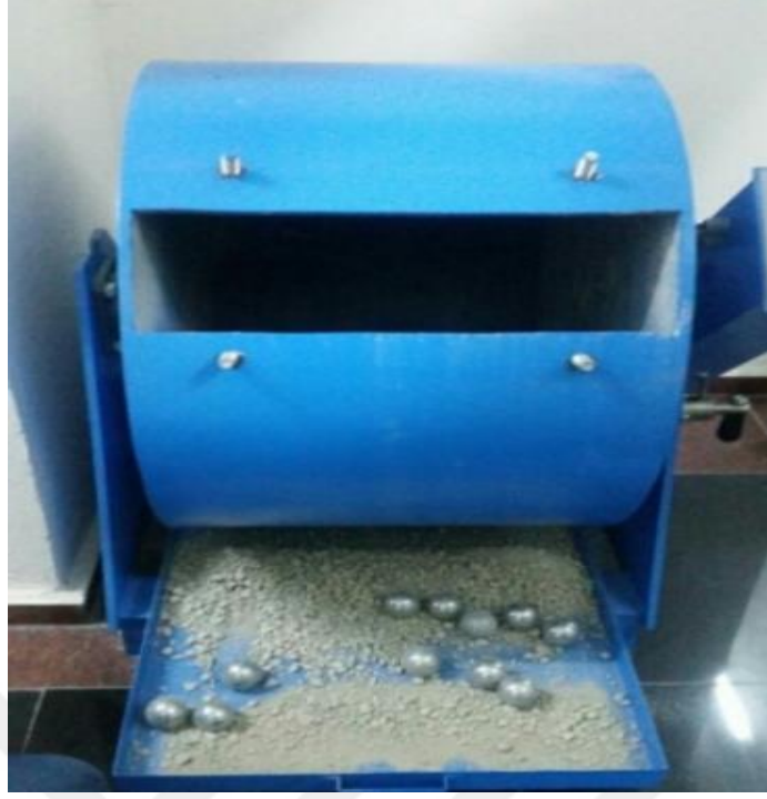
Şekil 4.9. Los Angeles aşınma deney cihazı
