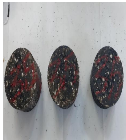
(d) %3.5 saf bitüm oranı ile hazırlanmış numuneler
