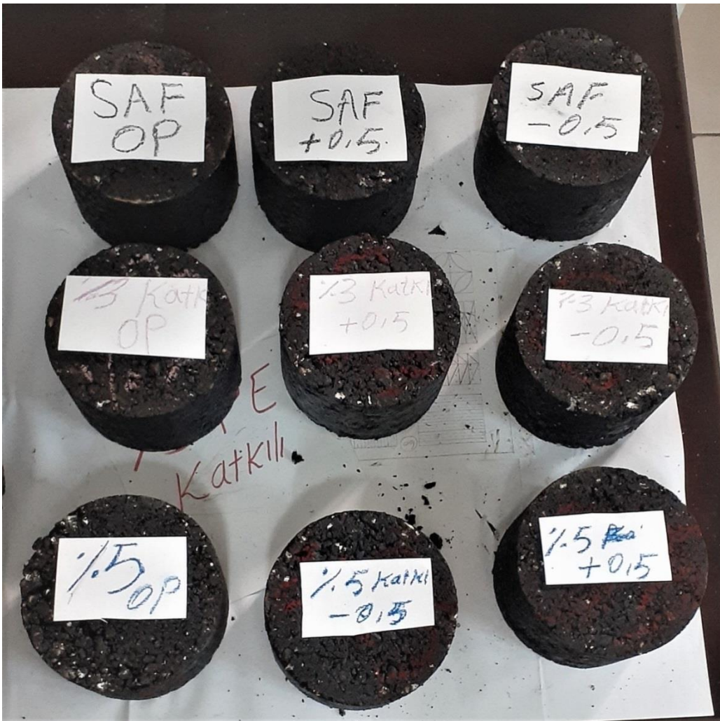
Şekil 6.16. GSM cihazında hazırlanmış numuneler
