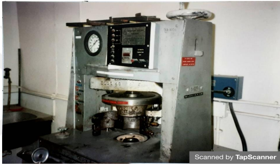
Şekil 2.7. Gyrator test makinesi (Leeds Üniversitesi Laboratuvarı)
