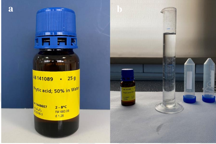
Resim 3.6. (a) %50'lik IP6 solüsyonu (b) %50'lik IP6 solüsyonundan %1'lik IP6 solüsyonunun hazırlanışı
