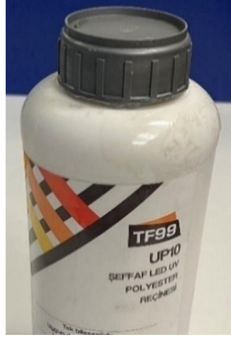
Şekil 3.2. LED UV ile kürlenen doymamış polyester reçine
