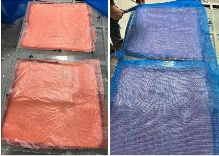
Şekil 3.11. Ayırıcı film ve akış filesi serimi
