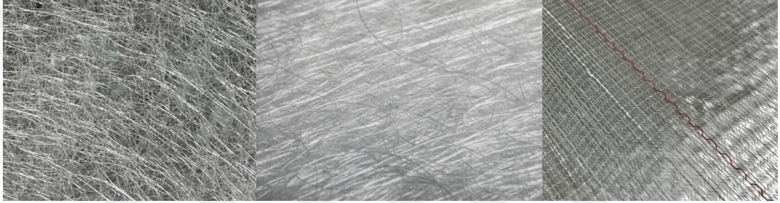
Şekil 3.1. Keçe, cfm ve quadraxial cam elyaflarının gösterimi
