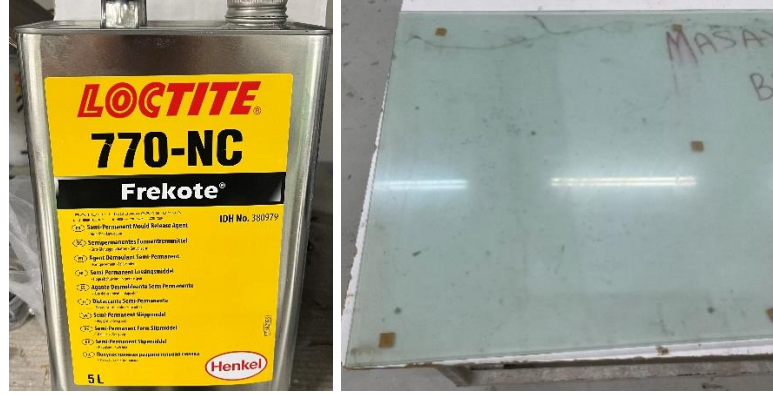
Şekil 3.8. Kalıp yüzeyinin kalıp ayırıcı ile parlatılması
