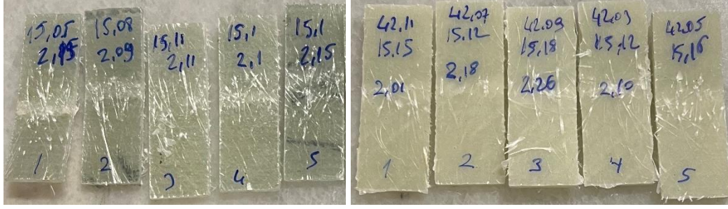
Şekil 4.15. Mekanik testler sonrası foto kür ve referans cam elyaf takviyeli kompozit numuneleri
