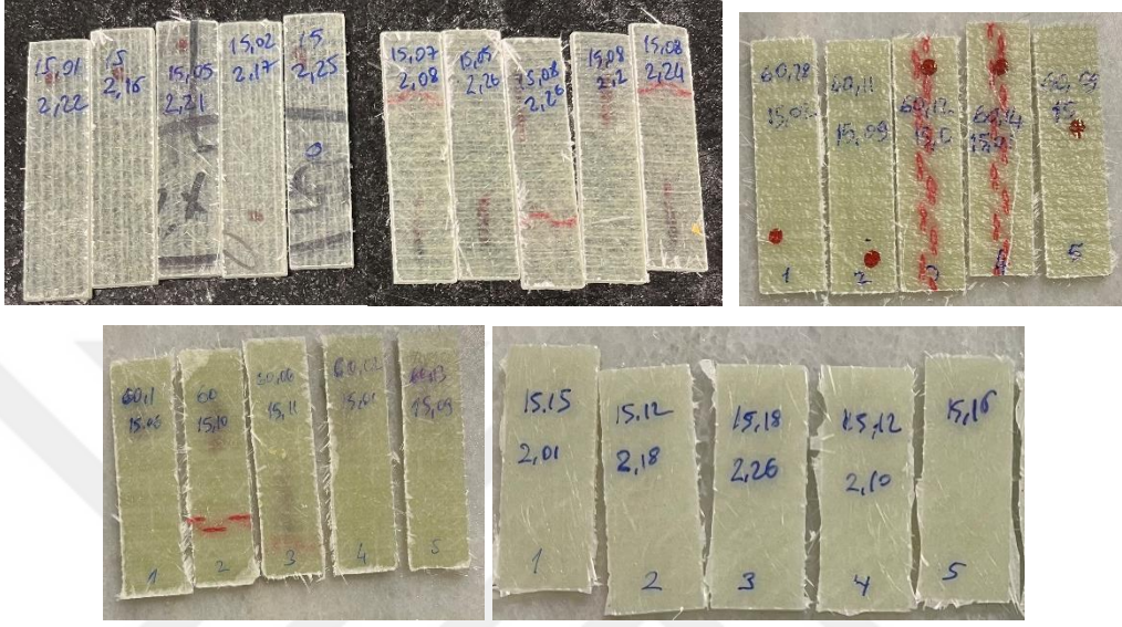
Şekil 3.21. Kumpas ile ölçülen üç nokta eğme testi numuneleri
