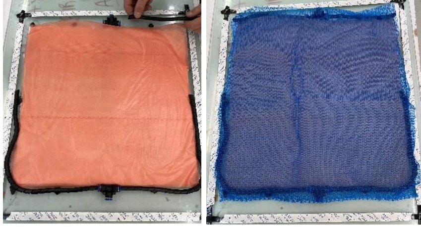
Şekil 3.12. T bağlantı ve spiral boruların yerleşimi
