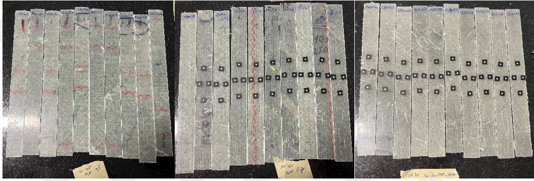
Şekil 3.18. Sırasıyla dört eksenli kumaştan 90° yönünde, 0° yönünde ve karışık formdaki fotobaşlatıcılı mekanik test numuneleri
