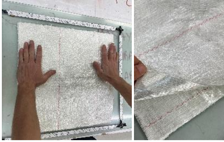
Şekil 3.10. Elyafların laminasyon planına göre serilmesi
