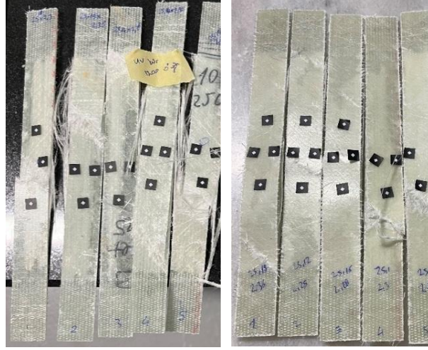
Şekil 4.6. Çekme testi sonrası 0° yönelimli foto kür ve referans test numuneleri
