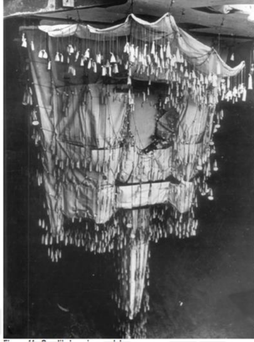
Şekil 2.2. Antoni Gaudi'nin farklı form varyasyonları üretebilmesine olanak tanıyan asılı modeli (Maher ve Burry, 2003, s. 46).
