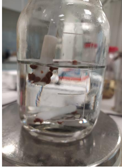
Şekil 3.21 : Üretilen çitosan manyetik boncuklarda görülen mıknatıs etkisi.
