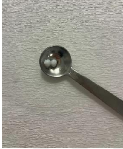
Şekil 3.22 : Üretilen PES kaplı sodyum aljinat boncuk.
