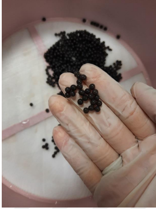
Şekil 3.18 : Üretilen manyetik nanokompozit boncuk.
