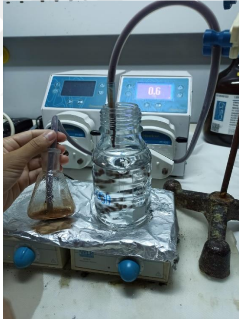
Şekil 3.20 : Çitosan manyetik boncuk üretimi.
