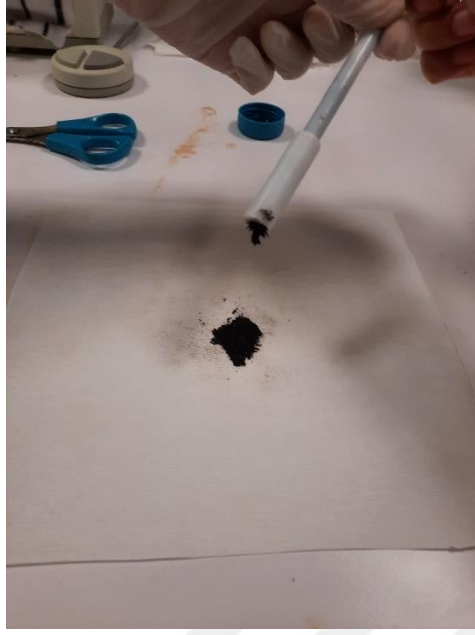
Şekil 3.16 : Sentezlenen manyetik Fe_3O_4 partikülü.
