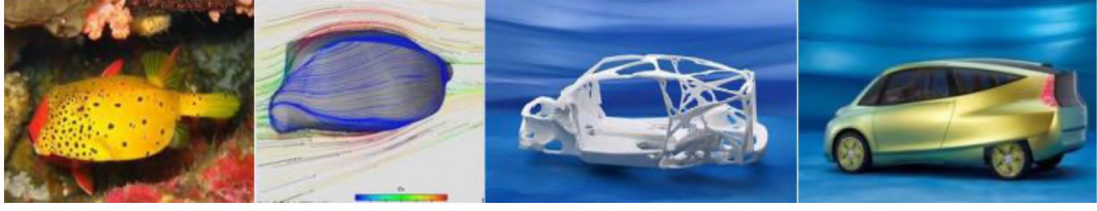
Şekil 1.26. Sandık Balığı ve Biyomimik Otomobil Tasarım Süreci
