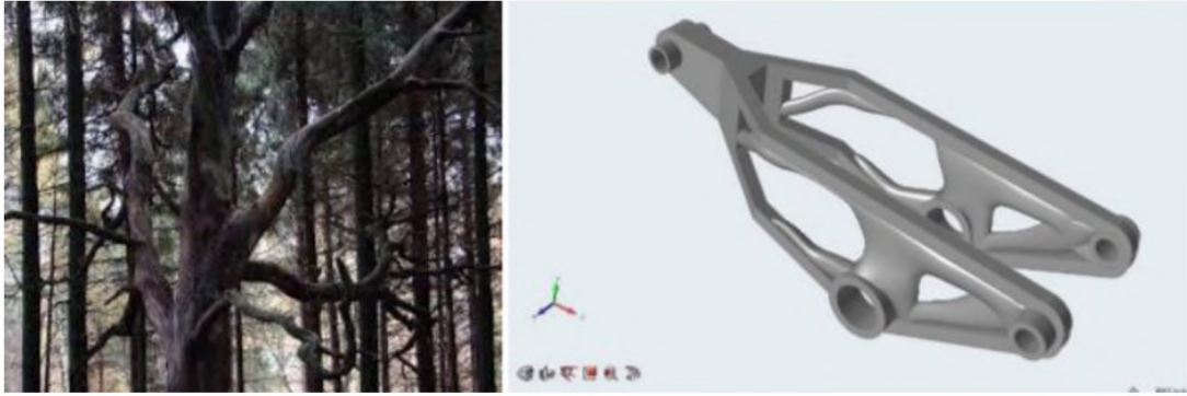
Şekil 1.21. Biyomimetik Çözüm Öneri Olarak “İskoç Çamı” ve Dal Formlarının Parça Üzerinde Uyarlanması
