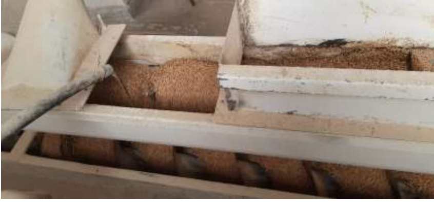
Resim 4.10. Buğdaya tav suyu verilmesi
