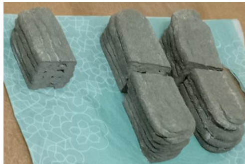
Şekil 3.10 Basınç dayanımı test numuneleri
