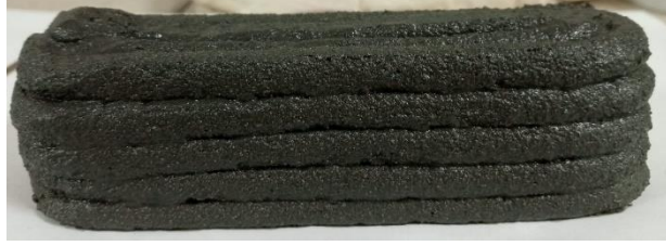
řekil 3.8 3B yazıcı ile retilen geopolimer har numunesi
