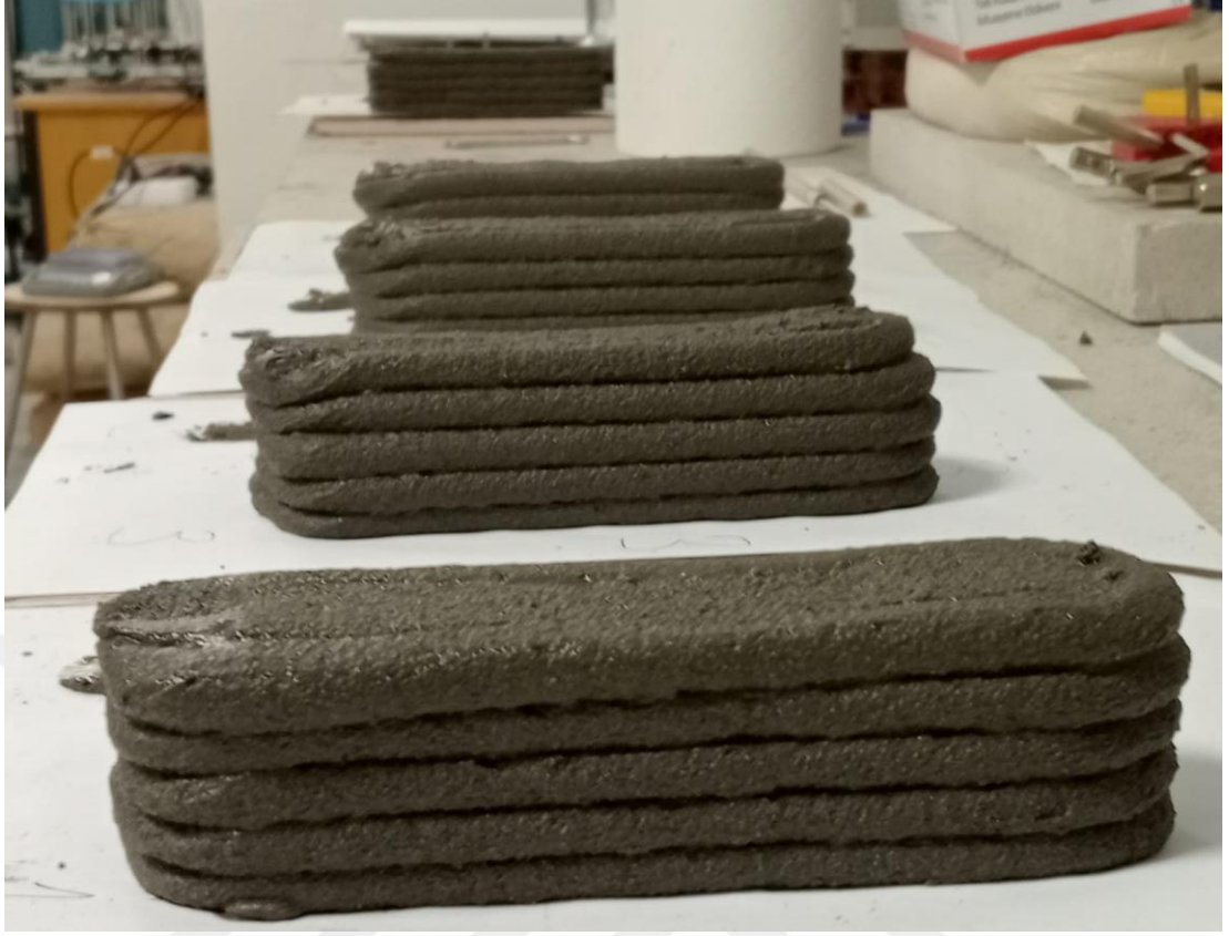
Şekil 3.7 3B yazıcı ile laboratuvarında üretilmiş geopolimer harç numuneleri
