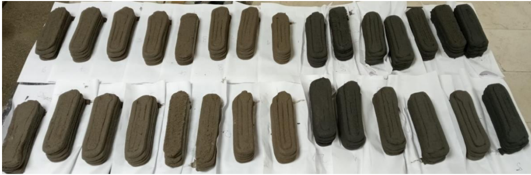
Şekil 4.1 3B yazıcı ile üretilen nanomalzeme içeren geopolimer harç numuneleri
