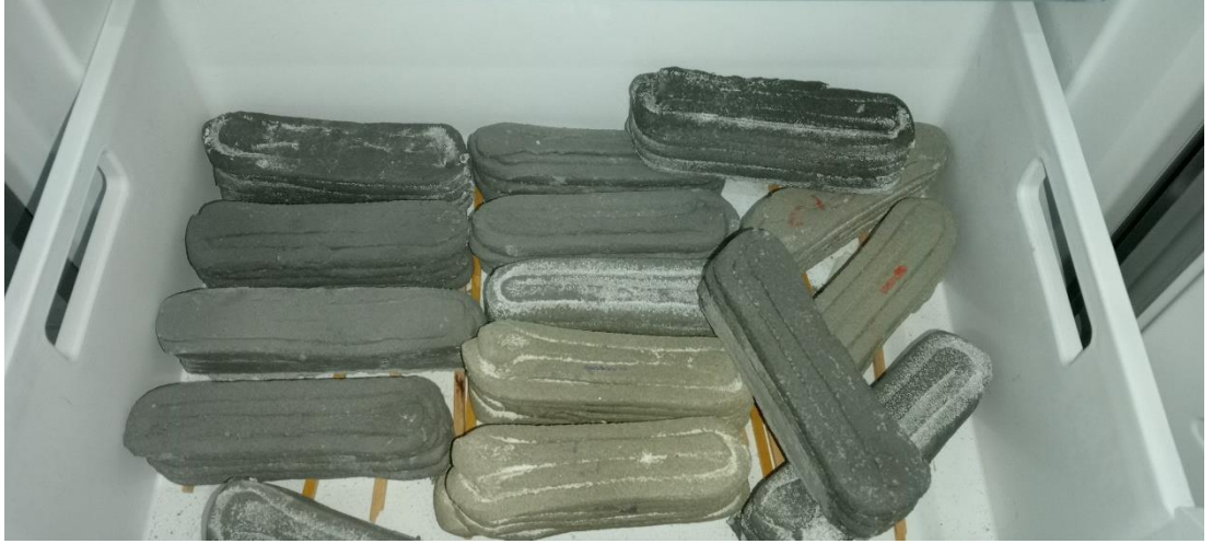
Şekil 4.12 Donma-çözülme deneyine maruz bırakılan numuneler
