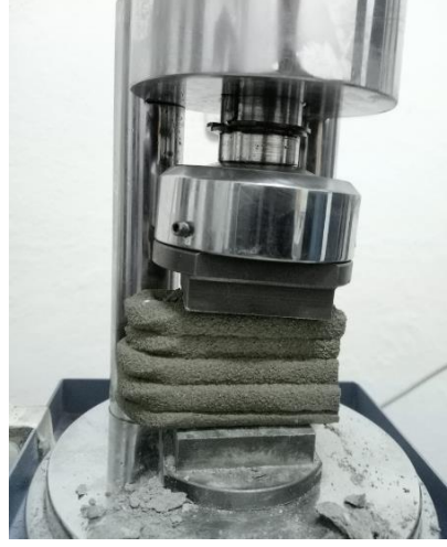
Şekil 3.11 Basınç dayanımı presinde test numunesi
