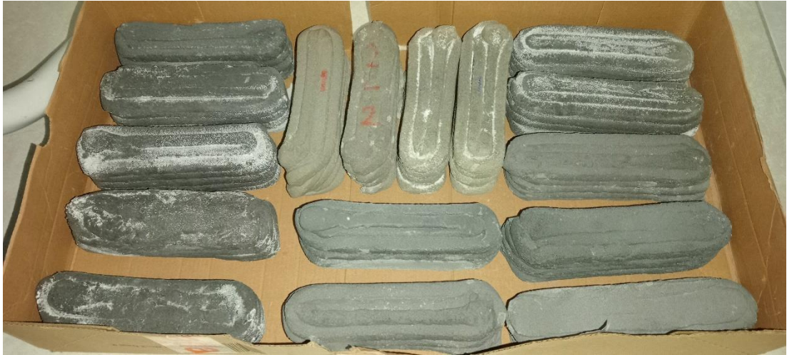
Şekil 4.13 Donma-çözülme maruz kalmış numuneler
