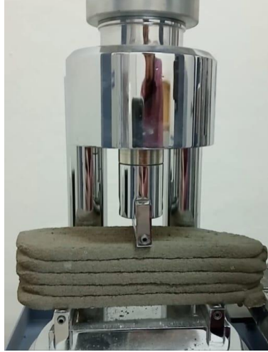
řekil 3.9 Eęilme dayanımı test numunesi
