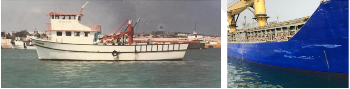
Şekil 4. Polat-1 Balıkçı Gemisi ve Çarpışma Sonrası Joelle Kuru Yük Gemisinde Oluşan Hasar (T.C. Ulaştırma ve Altyapı Bakanlığı, 2018)
