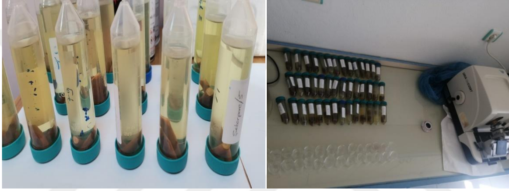
Şekil 3.7. Aşı örneklerinin FAA çözeltilisine alınması, kesit alımı için sıralanması ve kesit mikrotomundan bir görünüm
