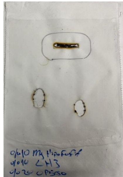
Şekil 3.51. OP560%20 + MgHipoFosfit %10 + LH3 %10
