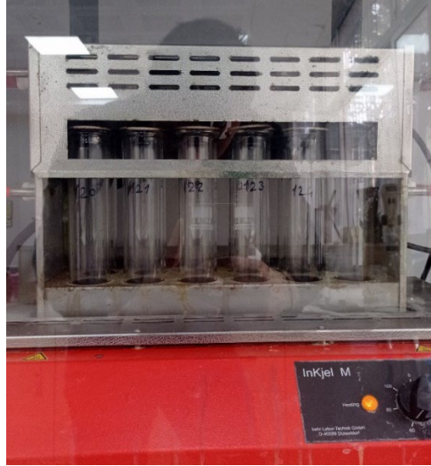
Şekil 3. 6. Yakma ünitesinde örnekler
