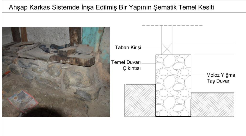
Şekil 3.12: Şematik Temel Kesiti (Karabulut 2023)
