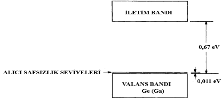
Şekil 3.20. Galyum (Ga) alıcı atomları içeren germanyum (Ge) kristali için enerji seviyesi diyagramı
