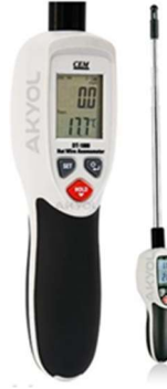
Şekil 6.9. Hava hızı ölçüm cihazı ve probu (anemometre).
