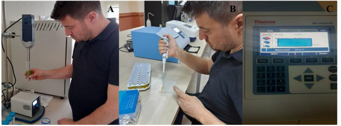
Fotoğraf 3.12. Yaprak örneklerinin homojenize edilmesi (A), TBA reaksiyonu sonrası MDA miktarlarının belirlenmesi için spektrofotometreye yüklenmesi (B) ve analizin gerçekleştirildiği spektrofotometre cihazı (C)
