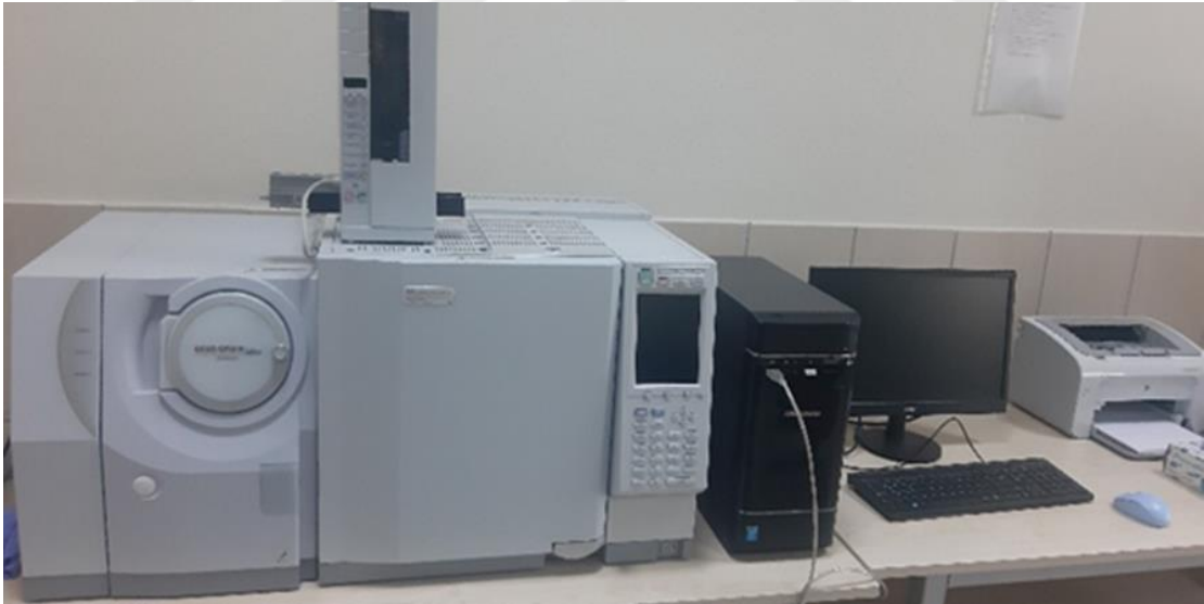
Fotoęraf 3.13. Kapsaisin analizlerinin gerekleřtirildięi Shimadzu QP2010 Ultra GC-MS sistemi
