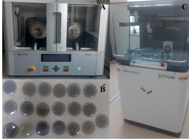
Fotoğraf 3.10. Claisse Eagon füzyon fırını (A), camsılaştırılmış numuneler (B) ve PANalytical Zetium XRF cihazı (C)
