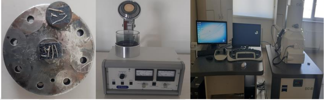
Fotoğraf 3.6. Mikorizal kök enfeksiyonunun SEM cihazında görüntülenmesi için hazırlanan kök numuneleri, Au-Pd kaplama cihazı ve Zeiss EVO-40 SEM cihazı
