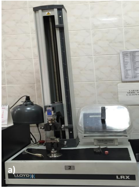
Resim 3.13. a) Üiversal mekanik test cihazı b) Bükülme dayanımı düzeneyi
