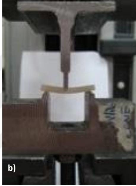
Resim 3.13. a) Üiversal mekanik test cihazı b) Bükülme dayanımı düzeneyi
