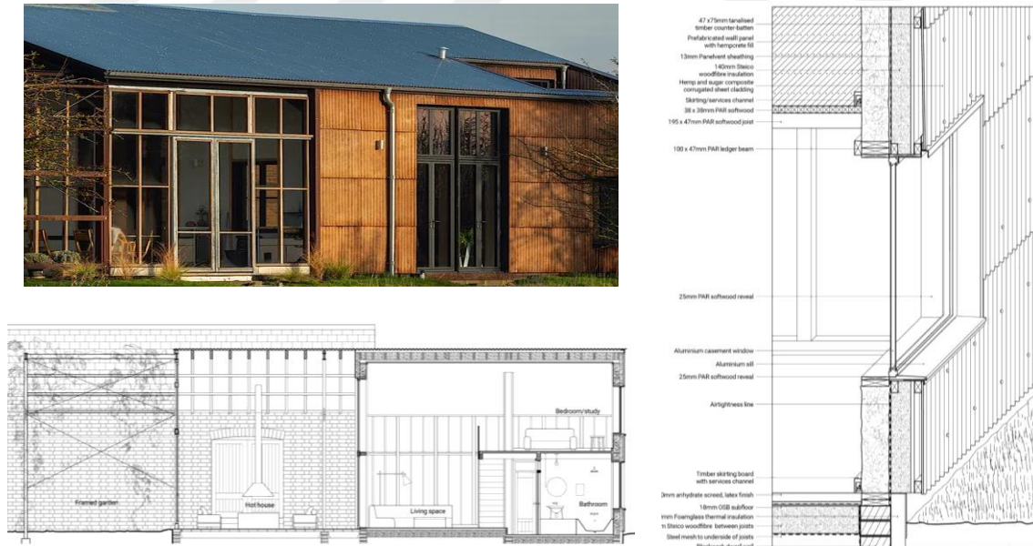
Şekil 20: Kenevir Malzemesi Kullanılarak Yapılan Konut (Flat House) (Pintos, 2020).
