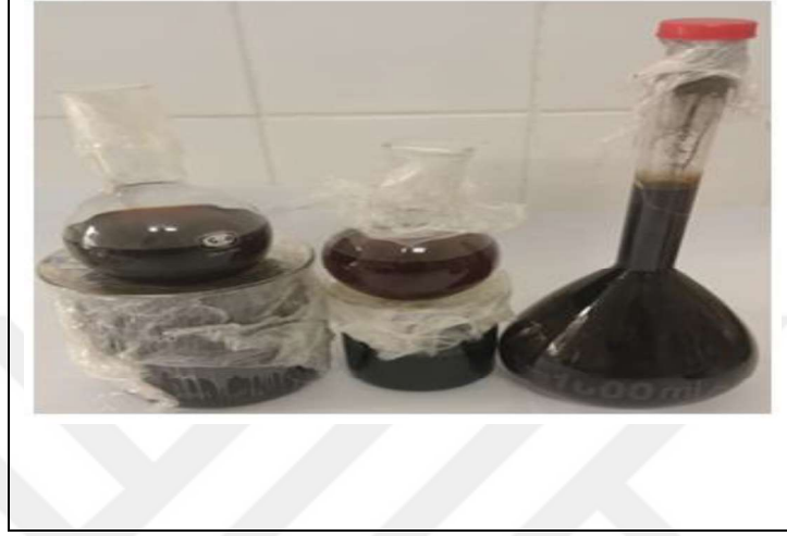
Şekil 3.6. Pyroliz İşlemi Sonucu Ortaya Çıkan Fındık ve Tavuk Sirkeleri
