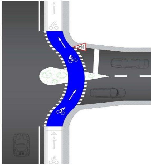
Şekil 2.19. Bisiklet yollarının kavşaklardaki damla adasından geçişleri (Bisiklet Yolları Yönetmeliği, 2019)
