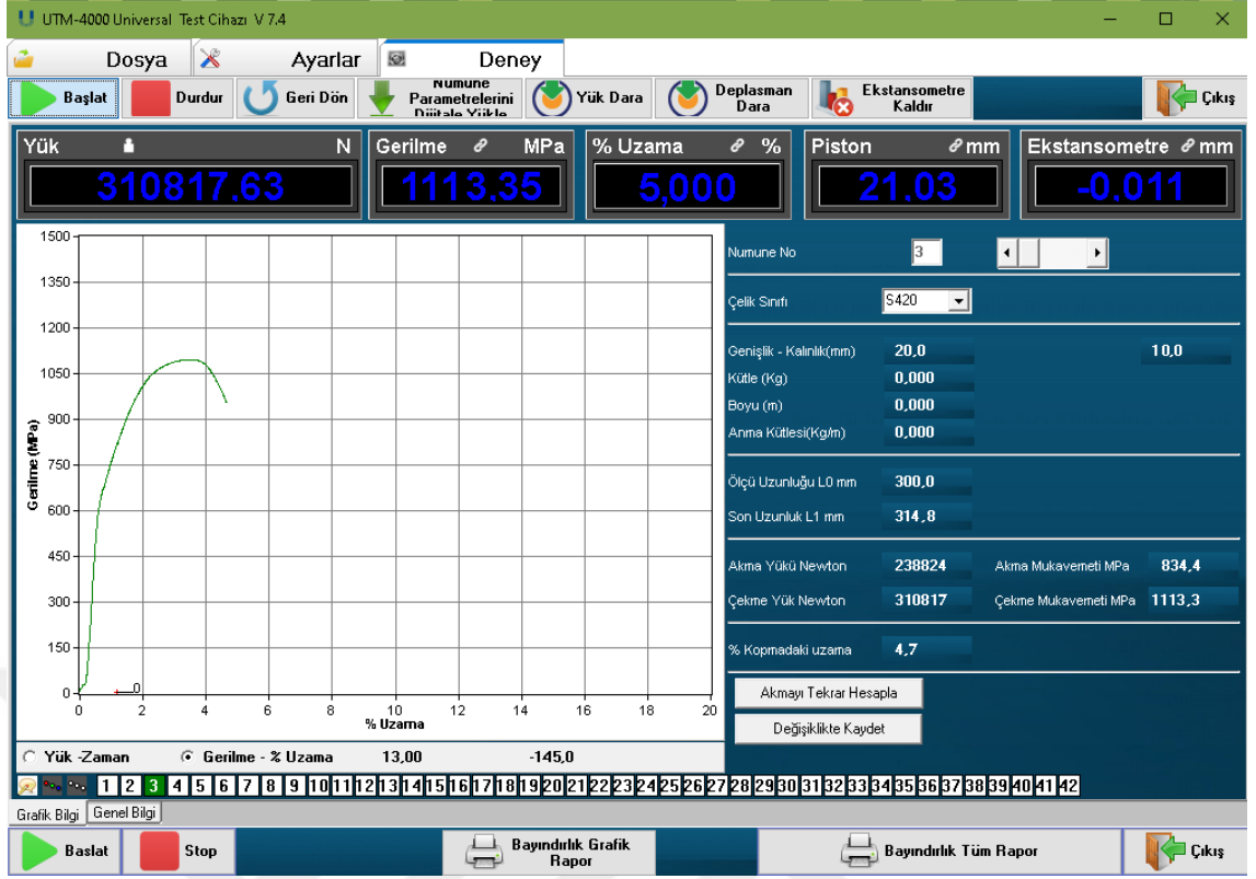
Şekil 4.7. Su verilmiş 54SiCr6 malzemesinin 3. çekme deney sonuçları
