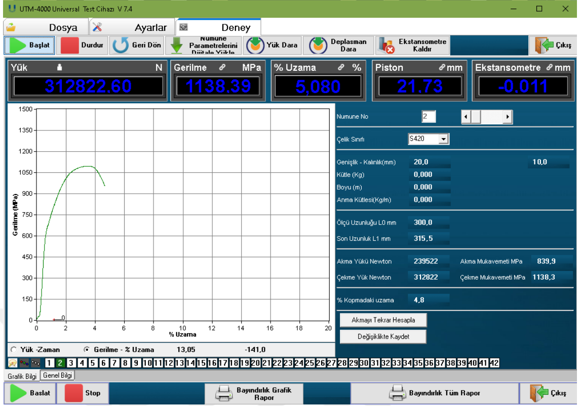
Şekil 4.6. Su verilmiş 54SiCr6 malzemesinin 2. çekme deney sonuçları
