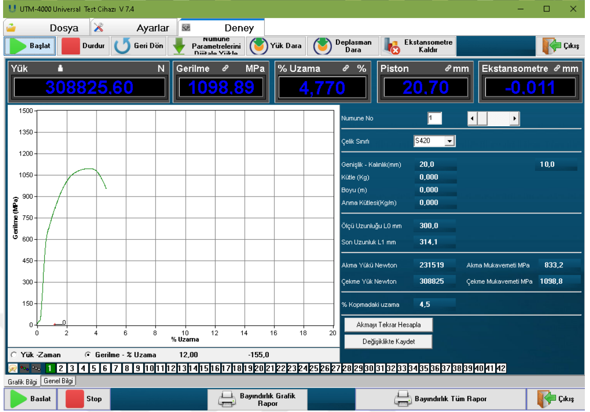
Şekil 4.5. Su verilmiş 54SiCr6 malzemesinin 1. çekme deney sonuçları
