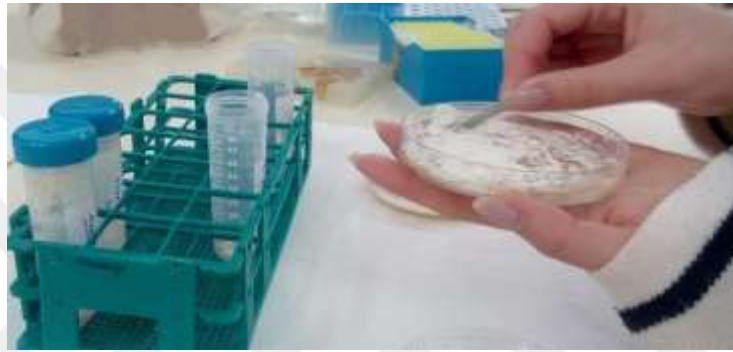
Şekil 3.4. Entomopatojen fungus izolatlarından kuru hasat yöntemi ile sporların elde edilmesi
