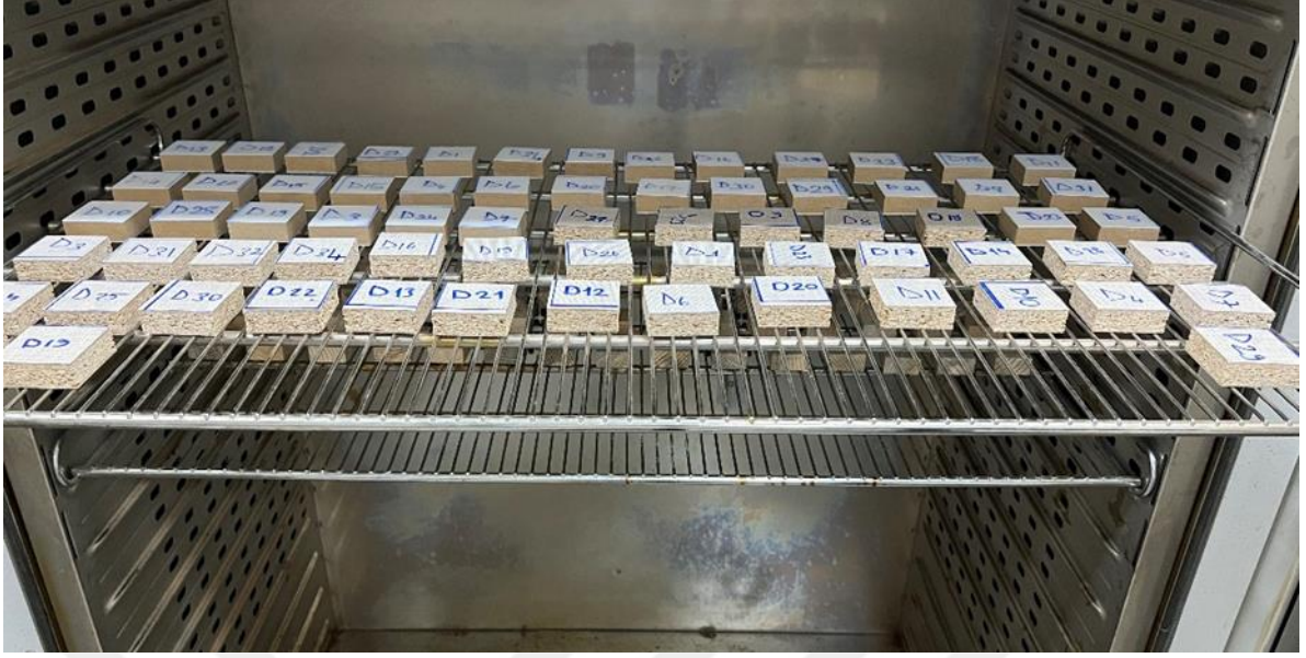
Şekil 3.17: Levhaların rutubet yoğunluğunun belirlenmesi için kurutulması.
