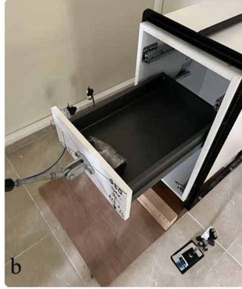
Şekil 3.36: Çekmecelerde uzatma elemanlarında dayanıklılık testi.
