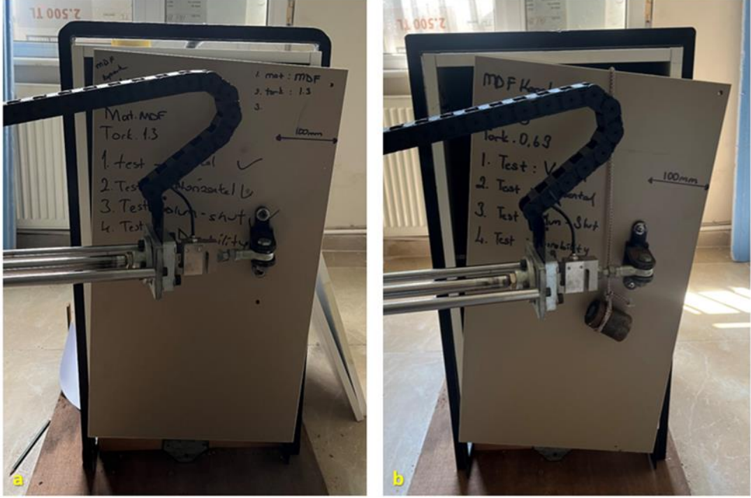
Şekil 4.15: Kapakların test bitimindeki son durumu; (a). MDF- 1,3N/m (b). MDF 0,63 N/m.
