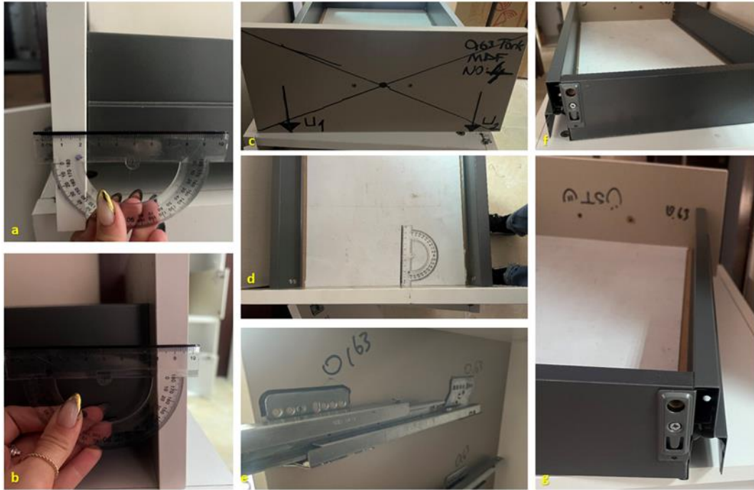
Şekil 5.6: MDF 0,63 N/m torkta montajlanmış çekmecelerin son durumu; (a). (b). Çekmece deformasyonu, (c). Ön kapak son durumu, (d). Altlık deformasyonu, (e). Ray son durumu, (f). (g). Çekmece altlığı, arkalık, ön kapak ve ray bağlantı elemanı.
