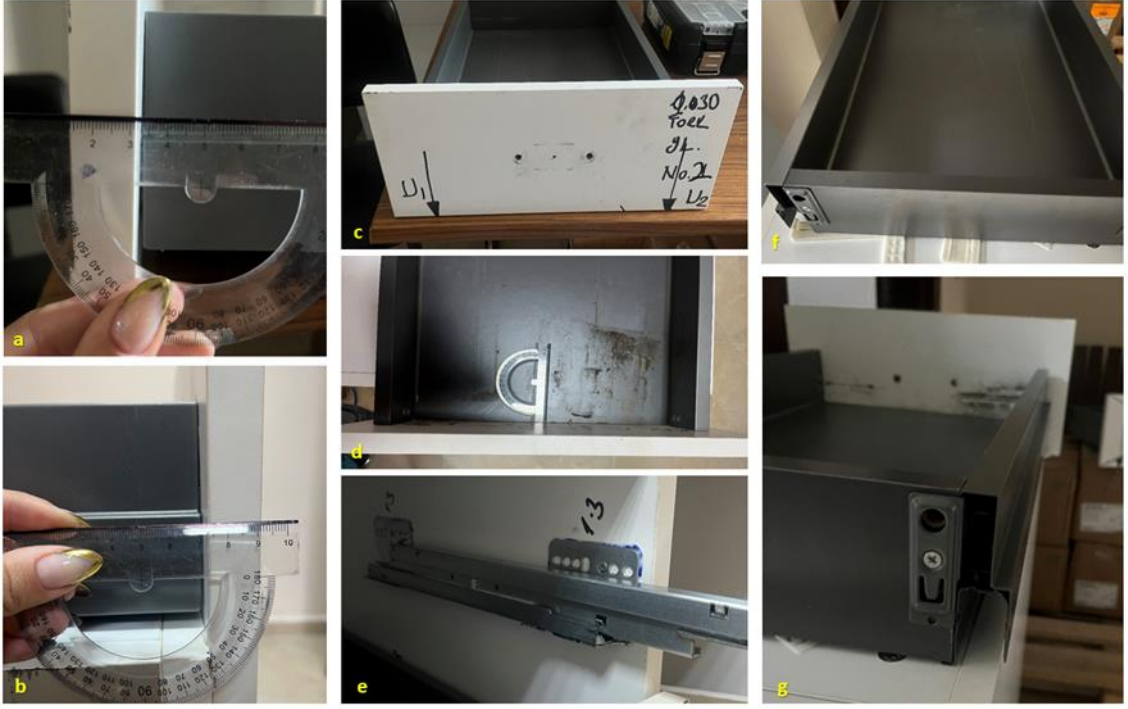
Şekil 5.7: YL 1,3 N/m torkta montajlanmış çekmecelerin son durumu; (a). (b). Çekmece deformasyonu, (c). Ön kapak son durumu, (d). Altlık deformasyonu, (e). Ray son durumu, (f). (g). Çekmece altlığı, arkalık, ön kapak ve ray bağlantı elemanı.
