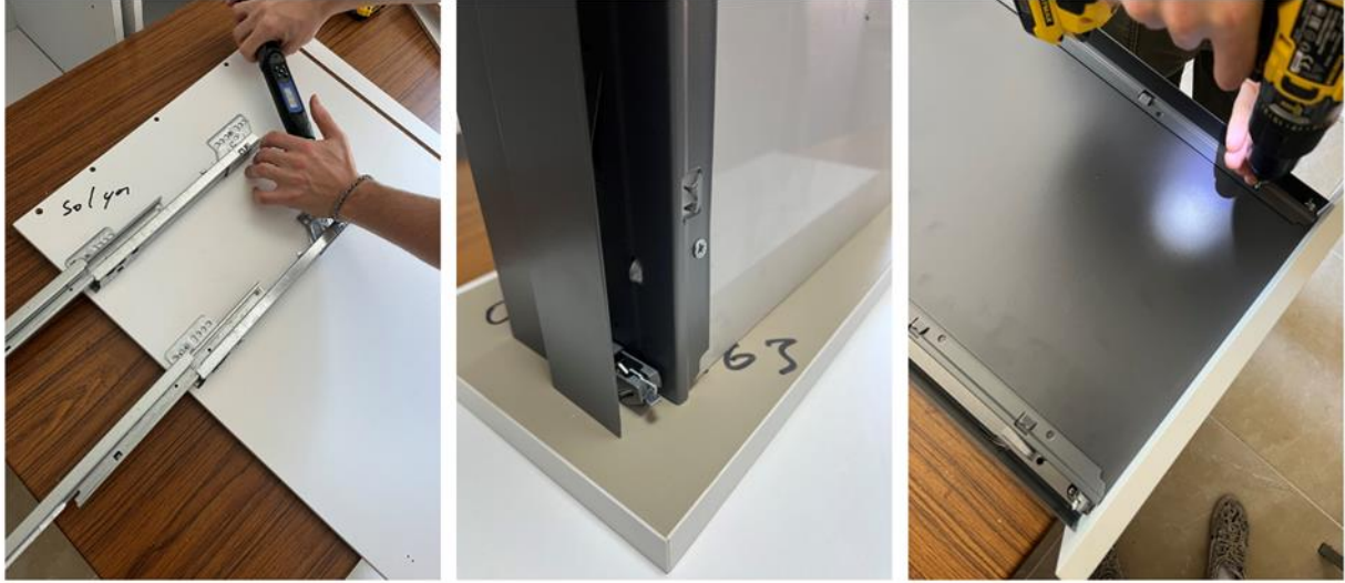
Şekil 3.12: Çekmece raylarının montajı.
