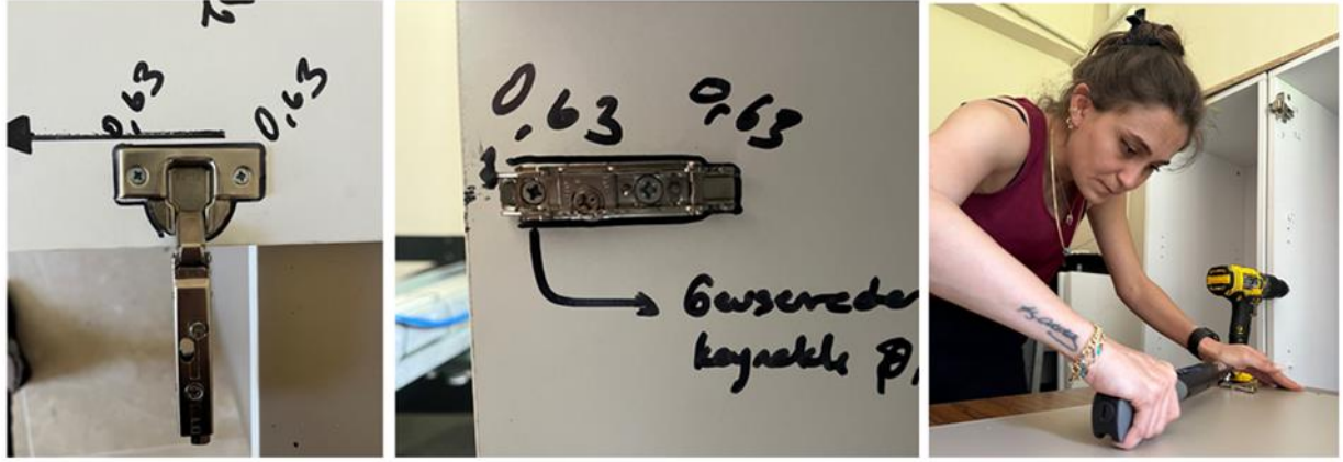
Şekil 3.10: Kapaklı numunelere ait menteşe montajı.
