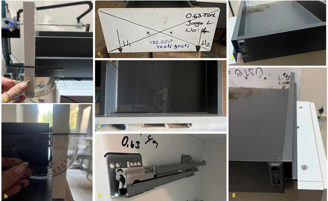
Şekil 5.8: YL 0,63 N/m torkta montajlanmış çekmecelerin son durumu; (a). (b). Çekmece deformasyonu, (c). Ön kapak son durumu, (d). Altlık deformasyonu, (e). Ray son durumu, (f). (g). Çekmece altlığı, arkalık, ön kapak ve ray bağlantı elemanı.
