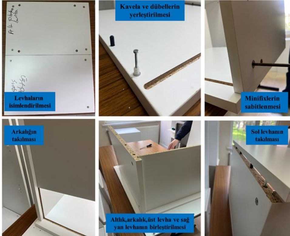
Şekil 3.9: Kabinlerin montajı.
