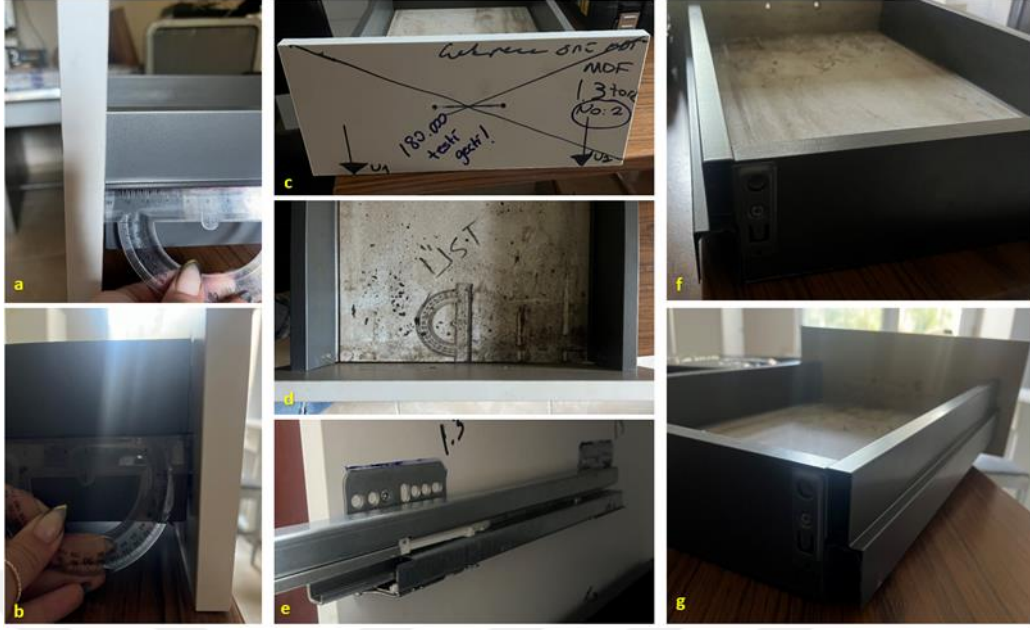
Şekil 5.5: 1,3 N/m torkta montajlanmış çekmecelerin son durumu; (a). (b). Çekmece deformasyonu, (c). Ön kapak son durumu, (d). Altlık deformasyonu, e. ray son durumu, (f). (g). Çekmece altlığı, arkalık, ön kapak ve ray bağlantı elemanı.
