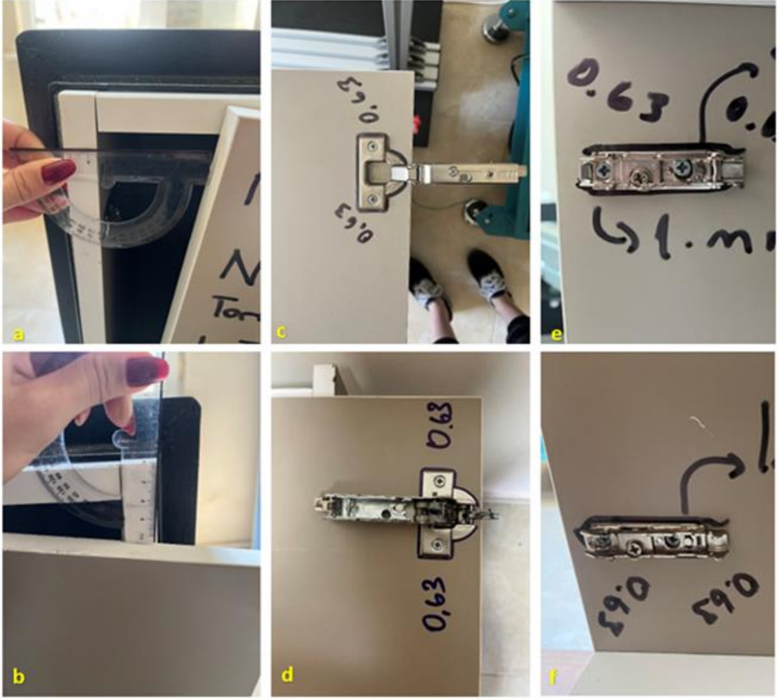
Şekil 5.2: MDF 0,63 N/m torkta montajlanmış kapakların son durumu; (a). Kapak menteşe deformasyonu, (b). Kapak deformasyonu, (c). Alt menteşe, (d). Üst menteşe, (e). Alt menteşe bağlantı elemanı, f. üst menteşe bağlantı elemanı.
