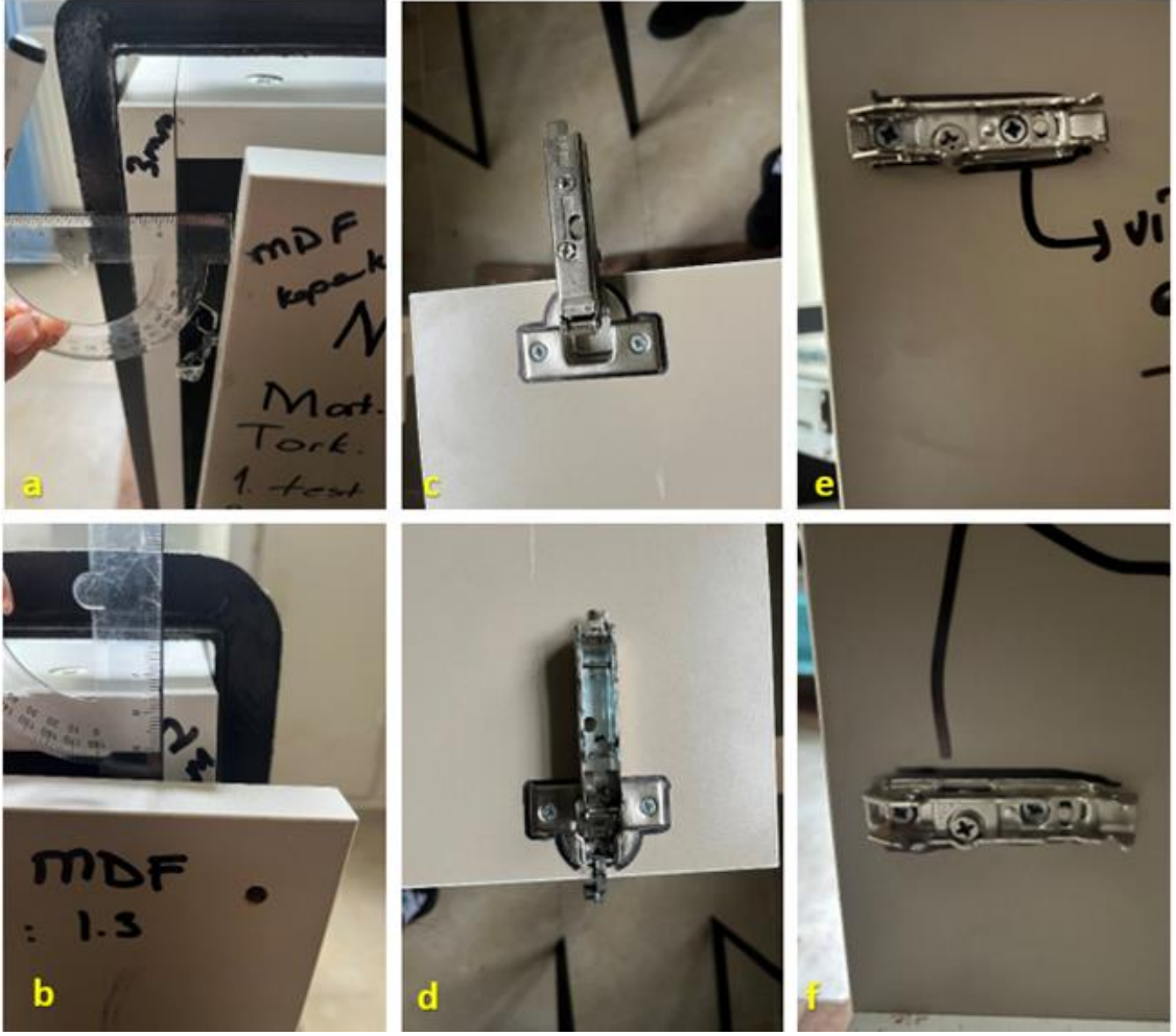
Şekil 5.1: MDF 1,3 N/m torkta montajlanmış kapakların son durumu; (a). Kapak menteşe deformasyonu, (b). Kapak deformasyonu, (c). Alt menteşe, (d). Üst menteşe, (e). Alt menteşe bağlantı elemanı, (f). Üst menteşe bağlantı elemanı.
