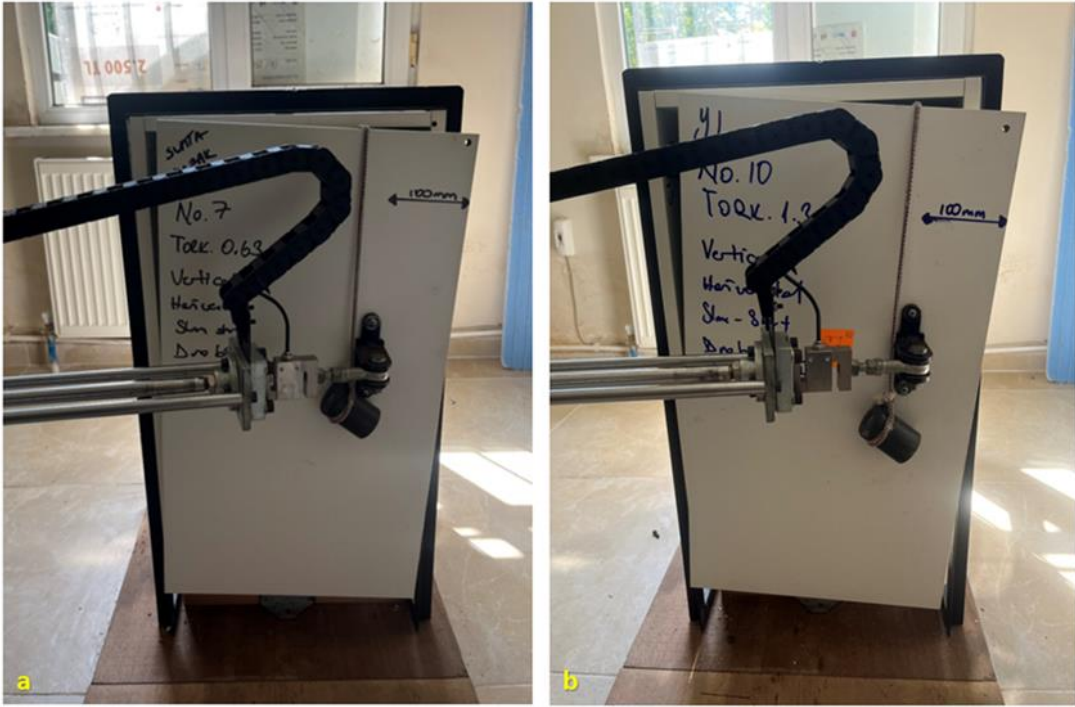
Şekil 4.16: Kapakların test bitimindeki son durumu; (a). YL- 1,3N/m (b). YL 0,63 N/m.
