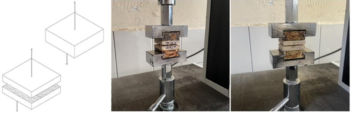
Şekil 3.25: Levha iç yapışma direnci deneyinin yapılması.
