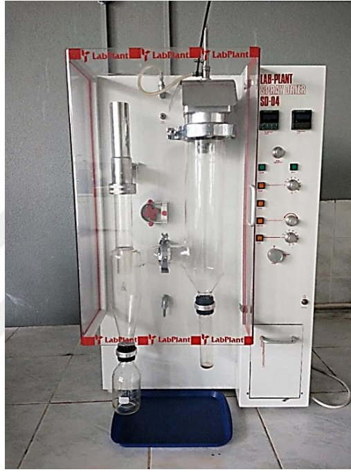
Şekil 3.7. Sprey kurutma işlemlerinde kullanılan sprej kurutucu
