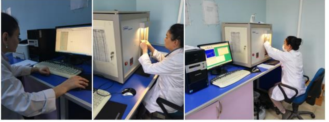
Şekil 3.18 Tiftik örneklerinin elastikiyet ve mukavemet ölçümlerinin yapılması
