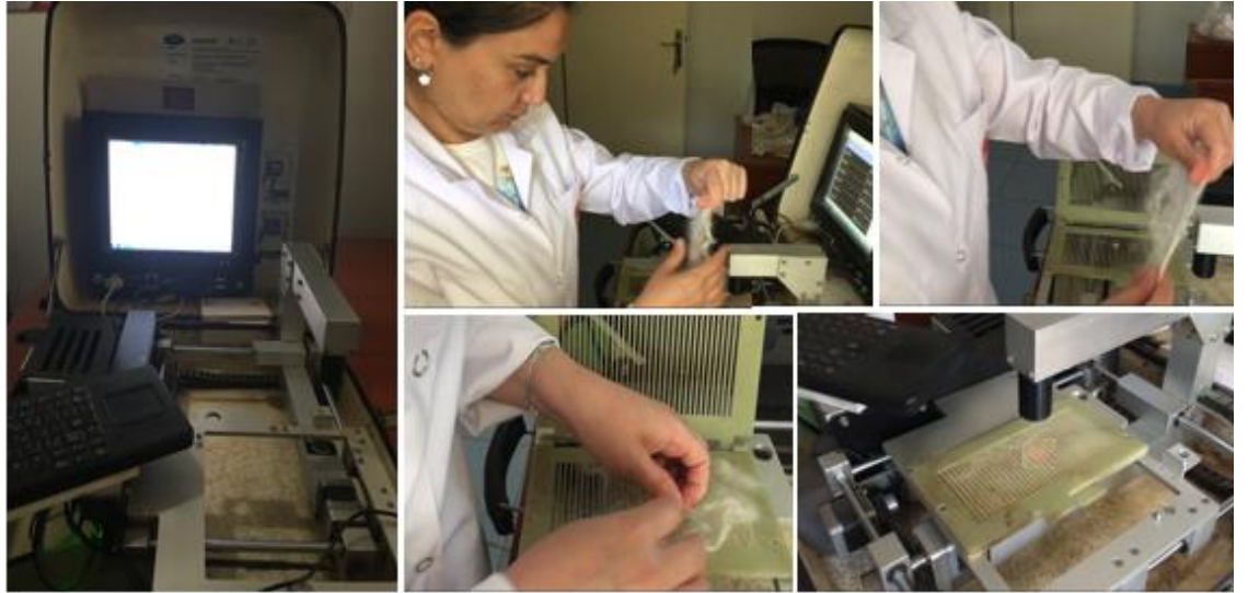
Şekil 3.17 Tiftik örneklerinin uzunluk ölçümlerinin yapılması
