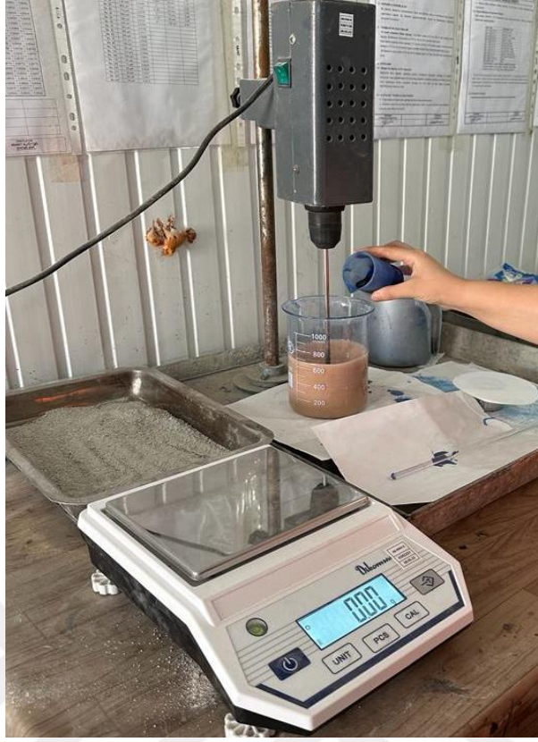
Şekil 4.8 Karışıma tartılan metilen mavisi çözeltisinin eklenmesi
