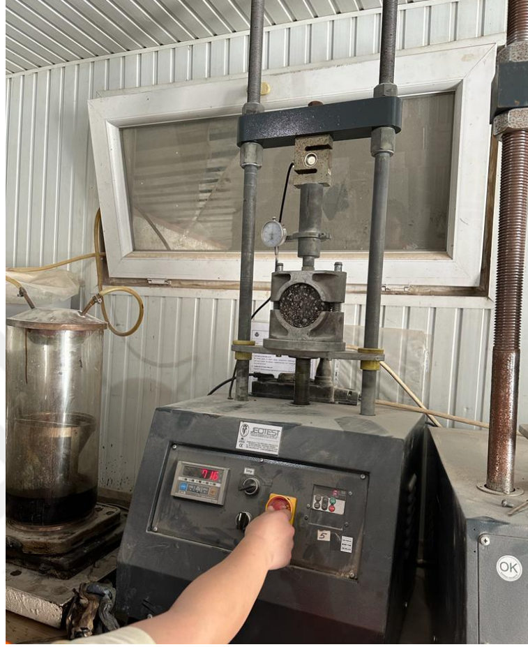
Şekil 3.13 Marshall deneyi stabilitesi ölçümü
