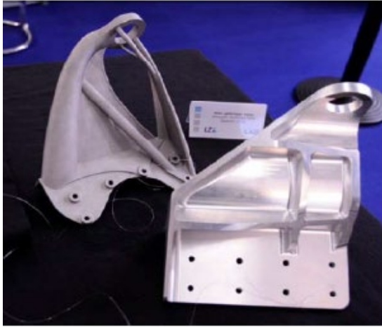
Resim 2.1. Eklemeli imalat ile üretilmek üzere modernize edilmiş bir uçak parçası [6]
