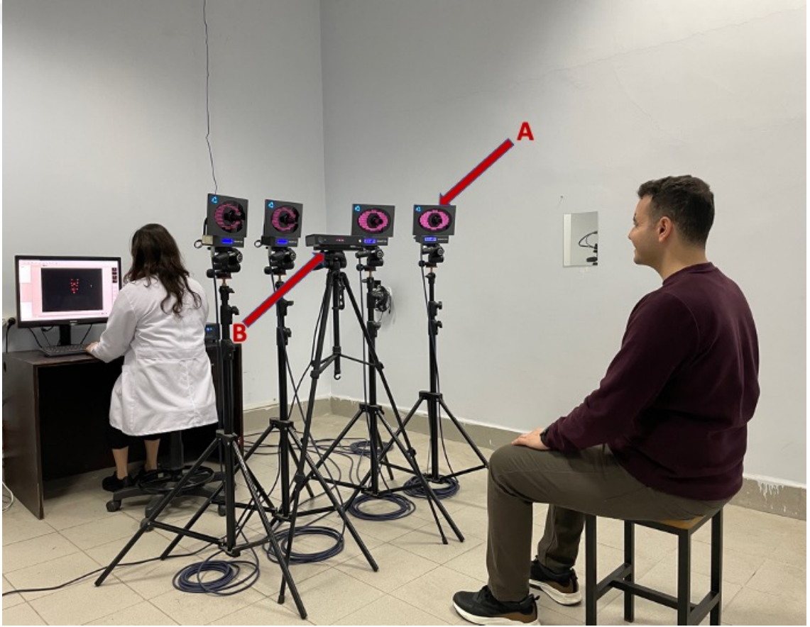
Şekil 3.3. Eş zamanlı optoelektronik markır tabanlı hareket analiz sistemi ve derinlik sensörü ile gülme hareketinin kaydedilmesi
