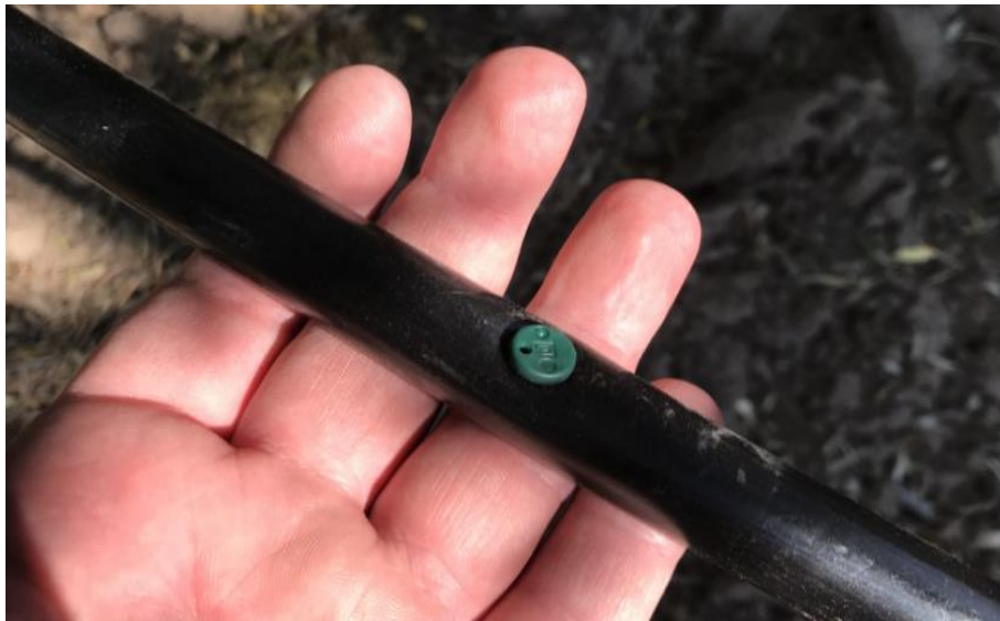
Resim 3.3. Lateral üzerinde katif damlatıcı
