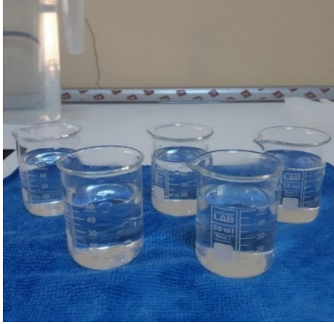
Şekil 3.6 NaOH çözeltisinin hazırlanması ve filmlerin banyo işlemi
