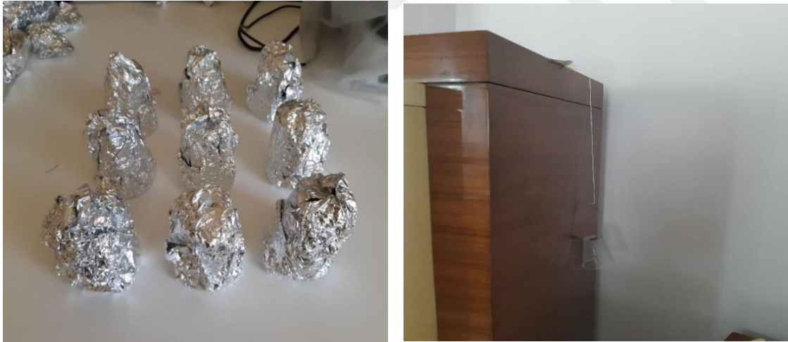
Şekil 3.5 a. Plastik bardakların folyo ile kaplanması. b. Filmlerin oda içindeki yerleşimi
