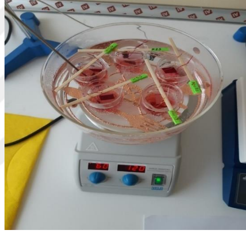
Şekil 3.6 NaOH çözeltisinin hazırlanması ve filmlerin banyo işlemi
