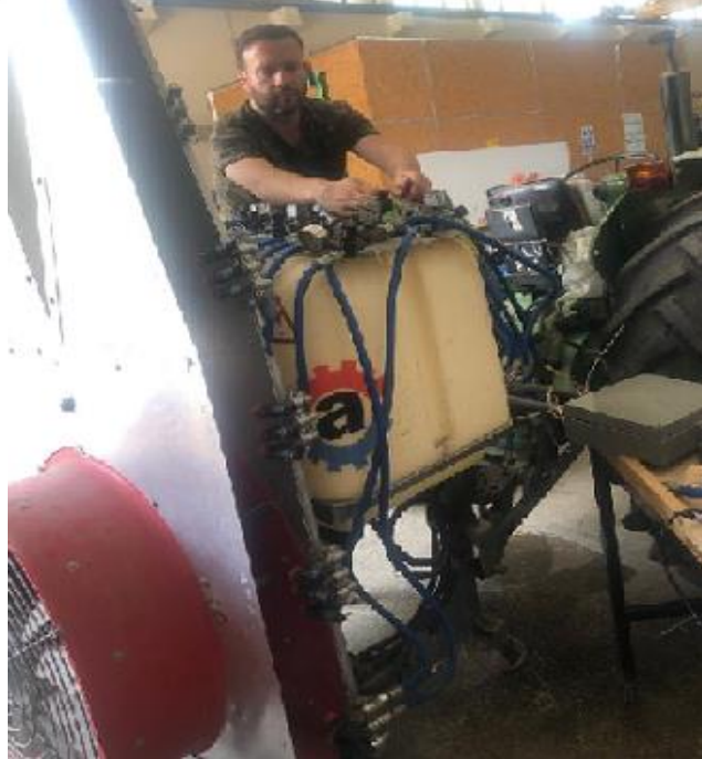
Şekil 3.18. Akıllı püskürtme sistemi ve elemanlarının birleştirilmesi.
