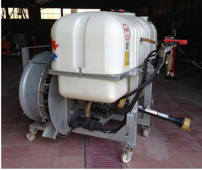
Şekil 3.2. Denemelerde kullanılan yardımcı hava akımlı bağ- bahçe pülverizatörü.
