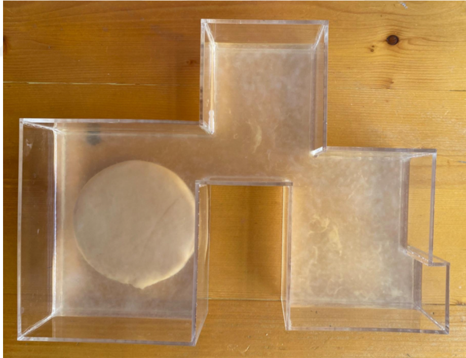
Şekil 62 : Mekân kroki şekline yapılmış kabın içerisinde SCOPY'yi oluşturmak için hazırlanmış sıvı
