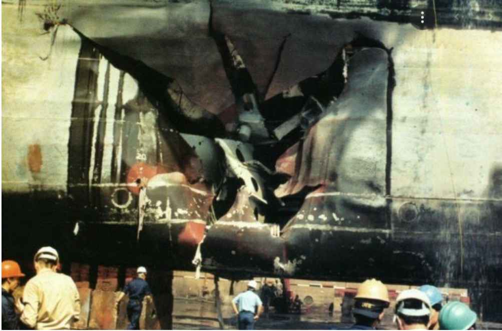
Şekil 2.11 : USS Tripoli yakın temas su altı patlaması [57].
