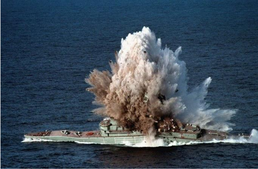
Şekil 2.4 : HMAS Torrens su altı patlaması testi, karinaya ilk şok dalgası teması sonraki aşama ve tekrar suya oturma öncesi [56].
