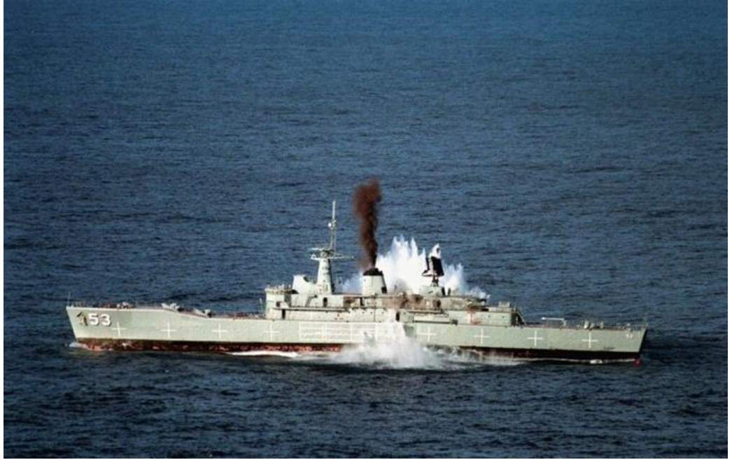
Şekil 2.2 : HMAS Torrens su altı patlaması testi, karinaya ilk şok dalgası teması [56].
