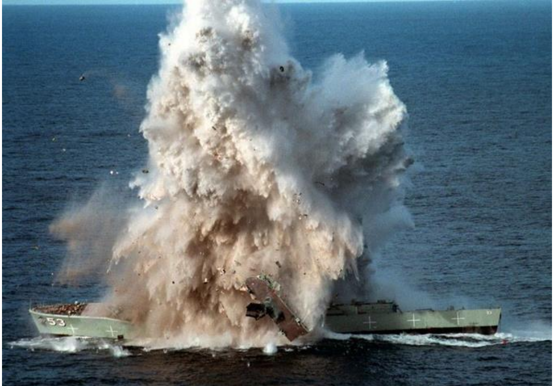
Şekil 2.6 : HMAS Torrens su altı patlaması testi, karinaya ilk şok dalgası teması sonraki aşama ve tekrar suya oturma ve ikinci kabarcık vuruşu [56].
