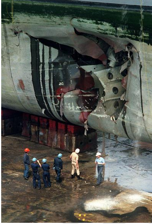
Şekil 2.10 : USS Tripoli yakın temas su altı patlaması [57].
