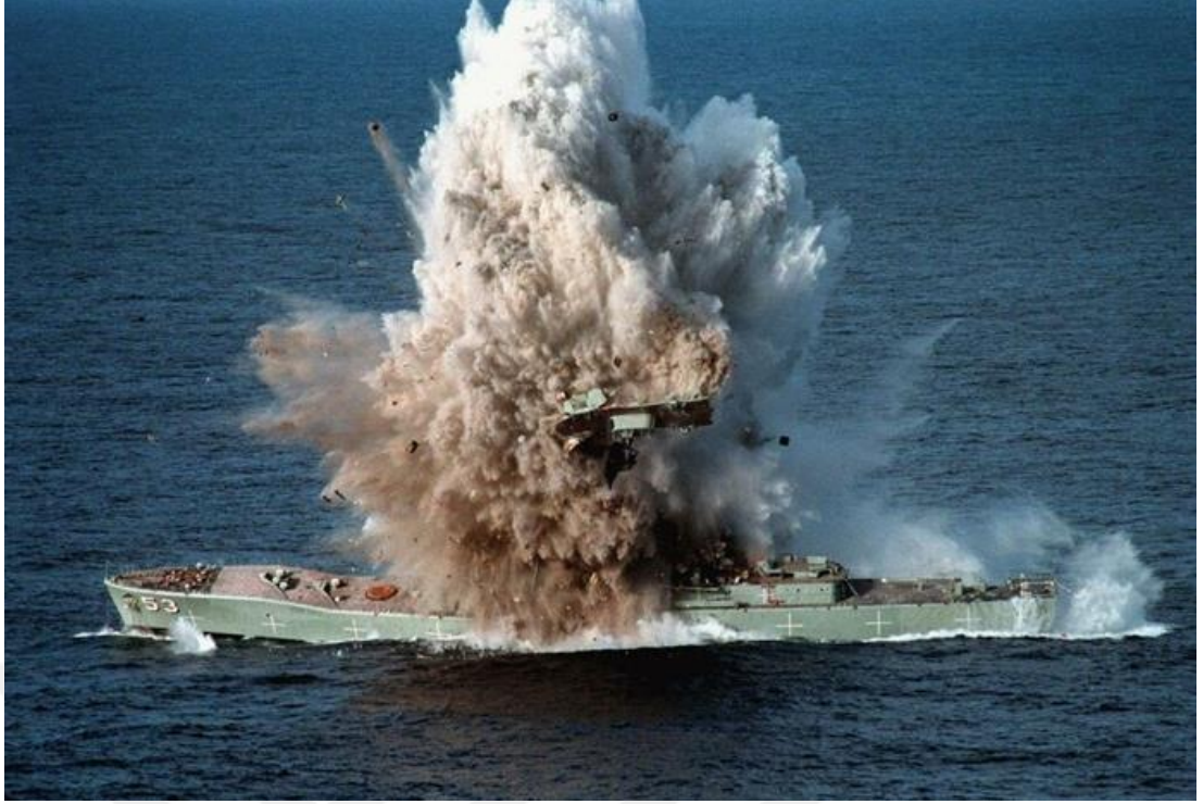
Şekil 2.5 : HMAS Torrens su altı patlaması testi, karinaya ilk şok dalgası teması sonraki aşama ve tekrar suya oturma [56].
