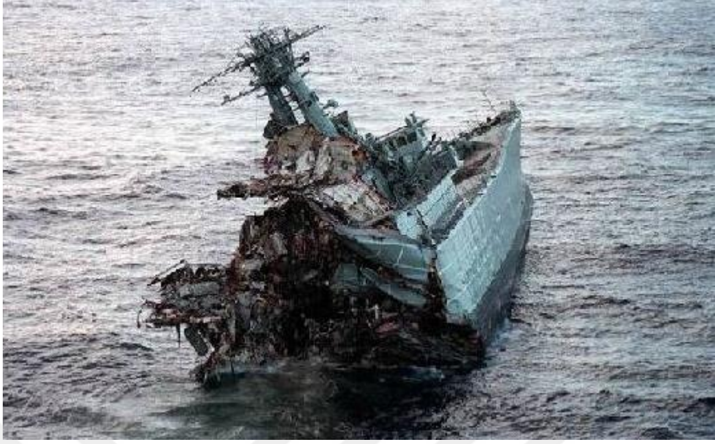
Şekil 2.9 : HMAS Torrens su altı patlaması testi, son durum [56].
