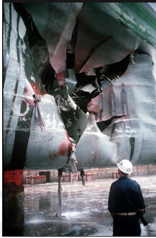
Şekil 2.10 : USS Tripoli yakın temas su altı patlaması [57].
