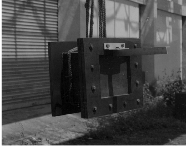
Şekil 4.3 : Kalıcı plaka deformasyonu ölçümleri için kullanılan deney düzeneği [80].
