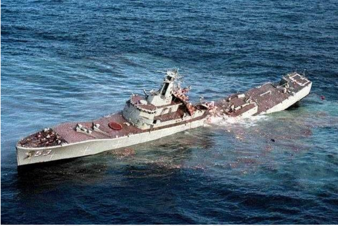
Şekil 2.7 : HMAS Torrens su altı patlaması testi, karinaya ikinci kabarcık vuruşu sonrası karinanın bölünmesi [56].
