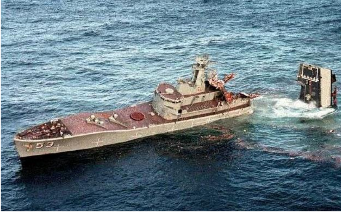
Şekil 2.8 : HMAS Torrens su altı patlaması testi, karinaya ikinci kabarcık vuruşu sonrası karinanın bölünmesi ve kış yapının tamamen gemiden ayrılması [56].
