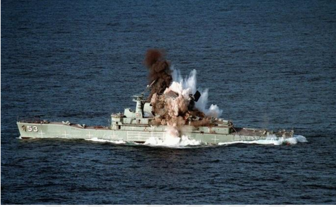
Şekil 2.3 : HMAS Torrens su altı patlaması testi, karinaya ilk şok dalgası teması sonraki aşama [56].
