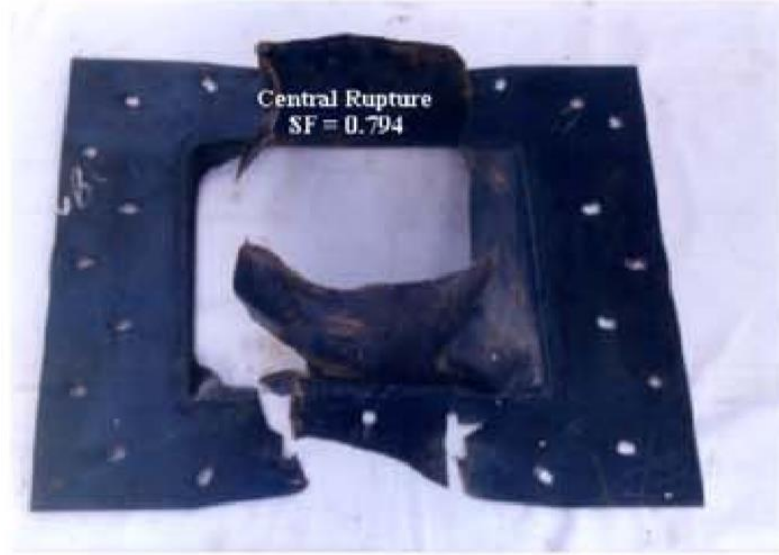
Şekil 4.45 : CEL 4_Y yırtılma analizlerinde deney neticesinde oluşan plakadaki deformasyon ve yırtılmalar [92].
