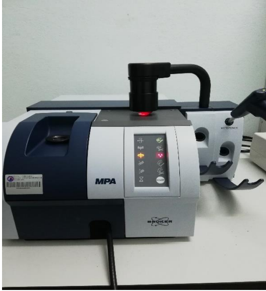
Şekil 8. Transmittans yöntemi ile ölçüm
