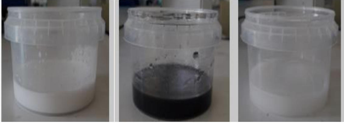
Şekil 4.3. Karıştırma işlemi tamamlanmış numuneler a) TiO_2 b) GNP c) Al_2O_3 .
