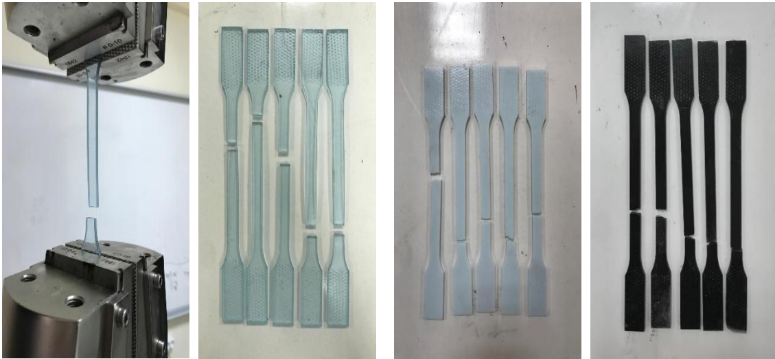
Şekil 4.10. Çekme testi ve numuneleri a) Çekme işlemi örneği b) TiO 2 c) Al 2 O 3 d) GNP.
