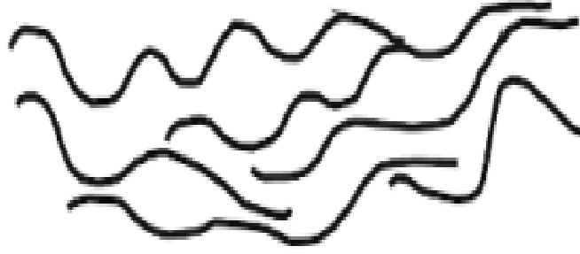
Şekil 2.2. Termoplastik malzemelerin şematize gösterimi [53].
