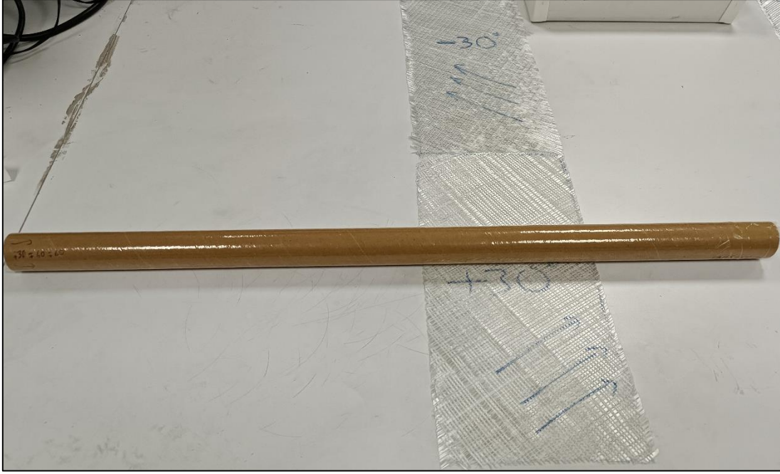
Şekil 4.9 Tek kat bantla sarılıp elyafa hazır hale gelen kalıp malzeme örneği
