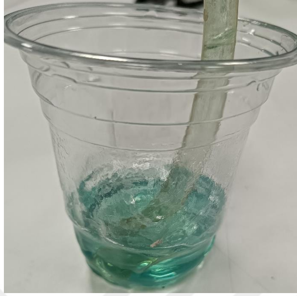
Şekil 4.20 Oda sıcaklığında 24 saat süre sonrasında kürleşen epoksi reçine
