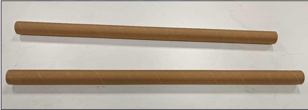
Şekil 4.1 Kalıp malzemesi olarak kullanılan 32 mm dış çapında karton silindirik çubuklar
