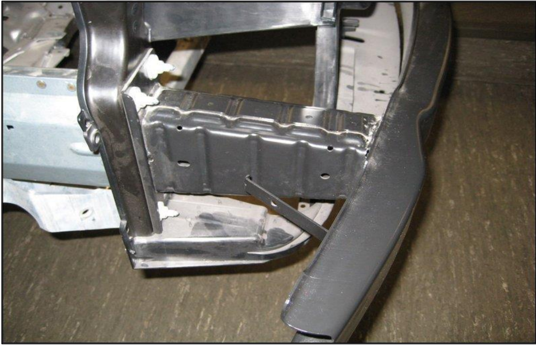
Şekil 2.2 Bir araç şasisine monte edilmiş çarpışma kutusu örneđi (Kayar, 2019)
