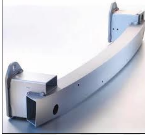
Şekil 2.1 Bir araca ait tampon ve çarpışma kutusu örneđi (Durgun vd., 2016)
