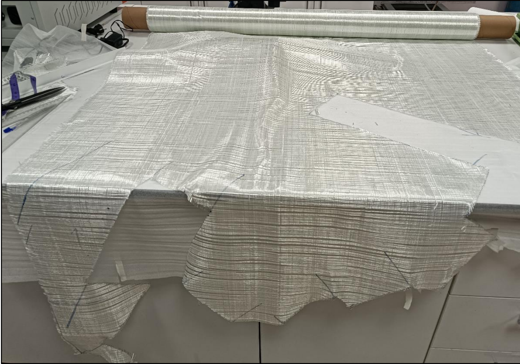
Şekil 4.8 Açılı kesimler sonucunda cam elyafının son görüntüsü
