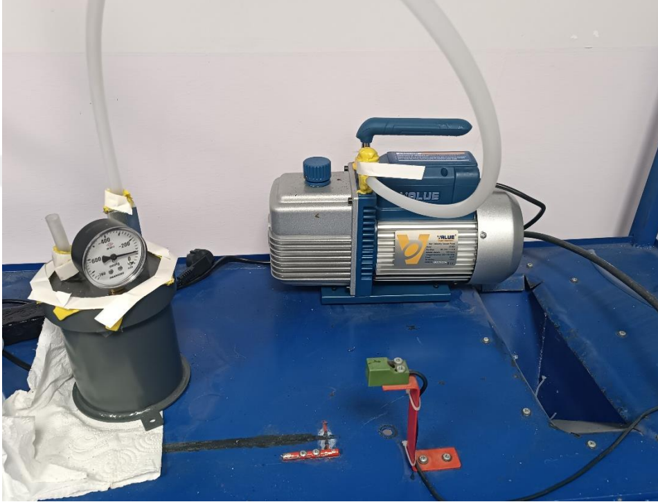
Şekil 4.15 Reçine geçişini sağlayan vakum pompası
