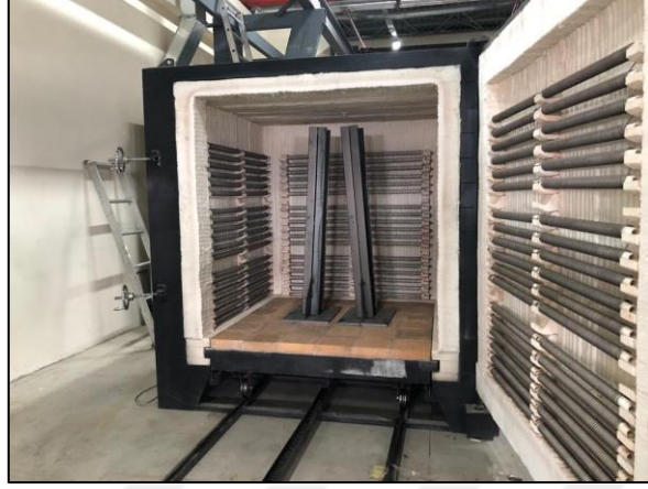
Őekil 4.3. Fırın ve Fırının İçine Koyulan KiriŐ Numuneleri
