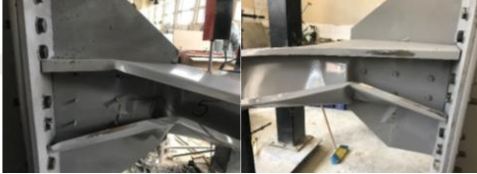
Şekil 2.6. Deney Göçme Modu ( Solak 2019)
